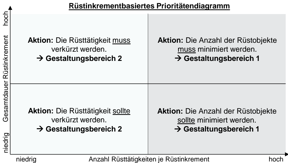
Abbildung 34: Segmentierung des rüstinkrementbasierten Prioritätendiagramms und Zuordnung zu den beiden Gestaltungsbereichen
