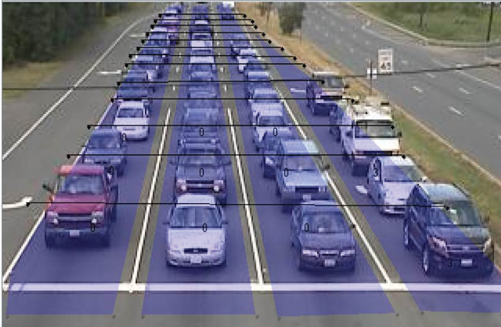
Bild 3.8 Nutzung von Videodaten zur Bestimmung von Rückstaulängen [RHYTHM ENGINEERING, 2016]
