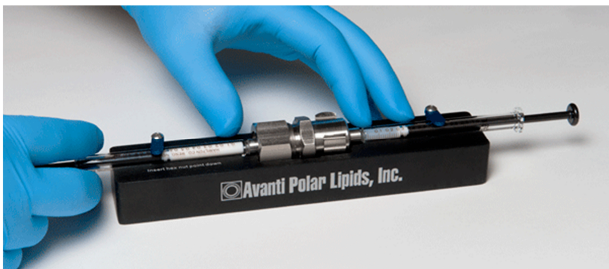
Abbildung 11: Mini Extruder von Avanti Polar Lipids; copyright: Avanti Polar Lipids, Alabaster, AL, USA.
