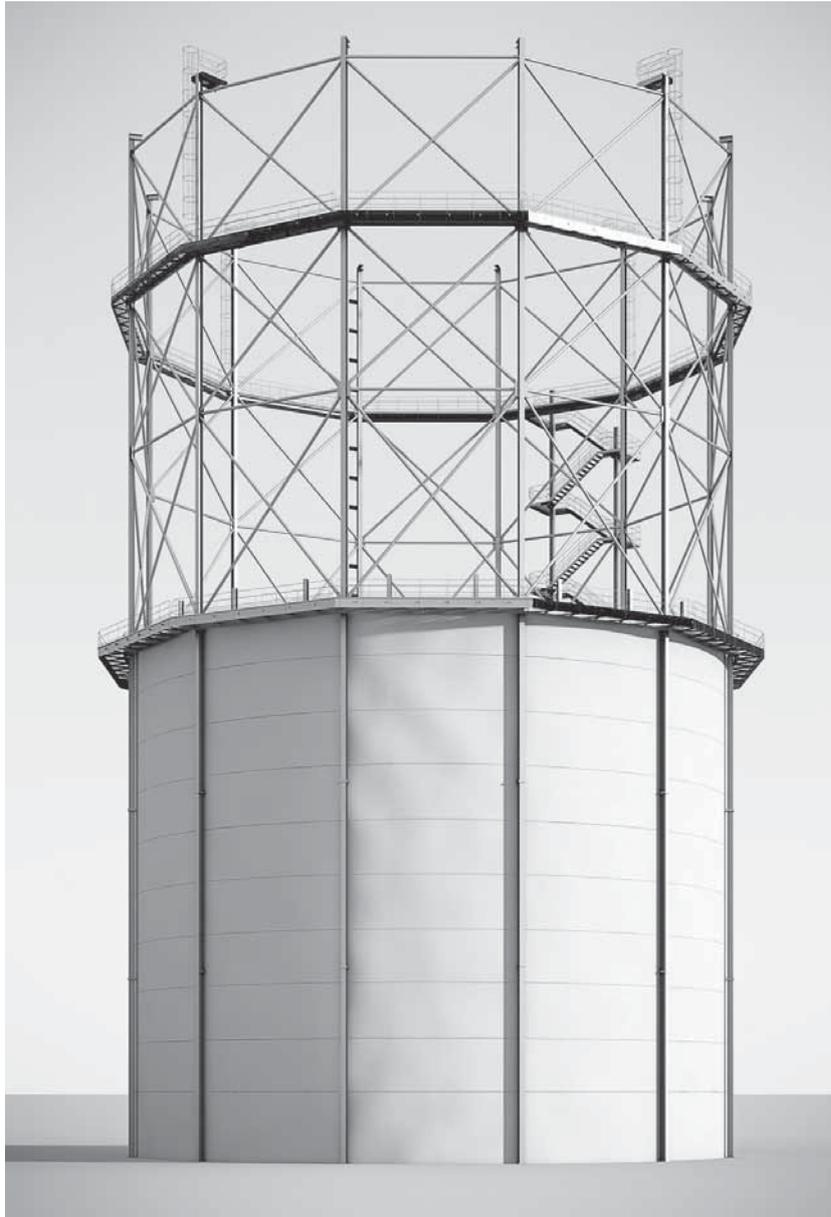
*Abb. 10: Rekonstruktion eines einhübrigen Gasbehälters mit freistehendem Flachbodenbecken (Giuseppe Giordano, 2017).*
