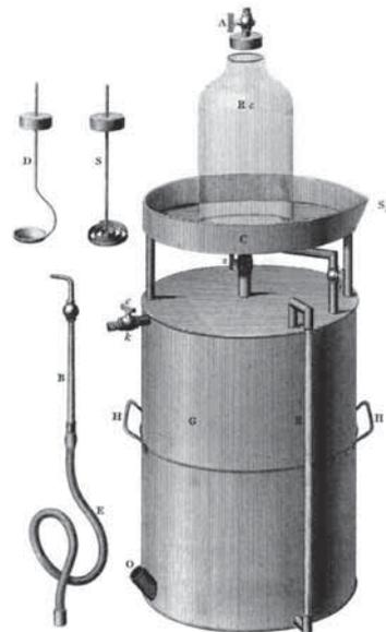
Abb. 13: Pepys Gasbehälter für Verbrennungsexperimente (Pepys, 1802, Pl. IV.).
