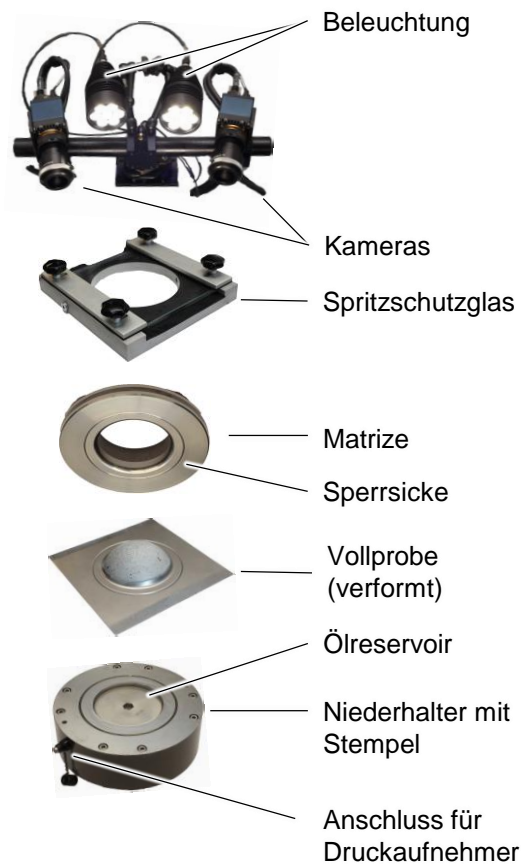
Abbildung 6.3: Aufbau des hydraulischen Tiefungsversuchs
