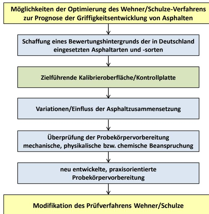
Abbildung 4-1: Untersuchungsprogramm für die Entwicklung einer praxisgerechten Probenvorbereitung
