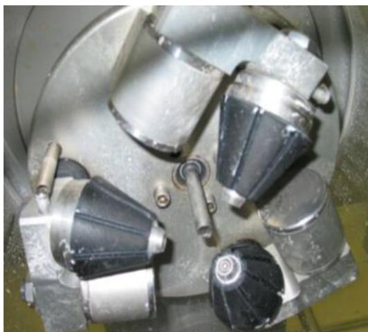
Abbildung 3-3: Detail Polierrollen mit Profilrillen
