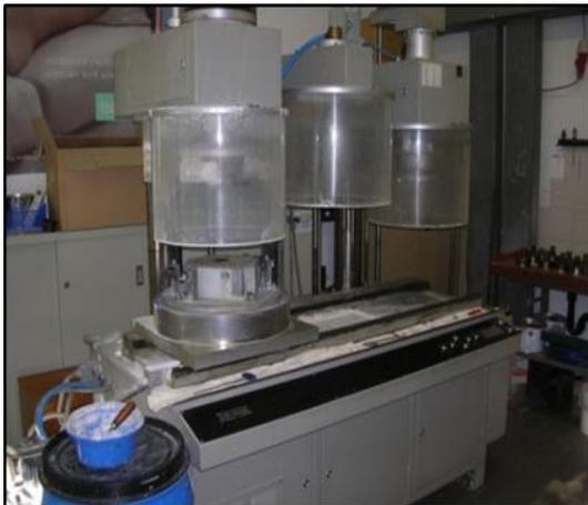
Abbildung 3-1: Prüfgerät Wehner/Schulze
