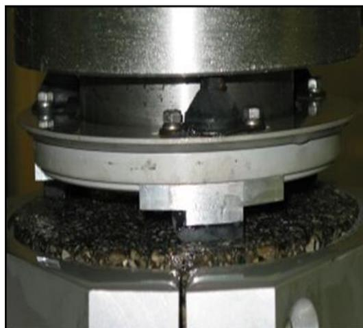
Abbildung 3-4: Messkopf (Griffigkeitsmessung)
