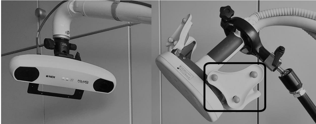
Abbildung 4: Das Infrarotnavigationssystem der nTMS Einheit
