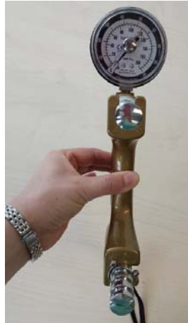
Abbildung 21: Manometer zur Bestimmung der Willkürmotorik mit Zangengriff
