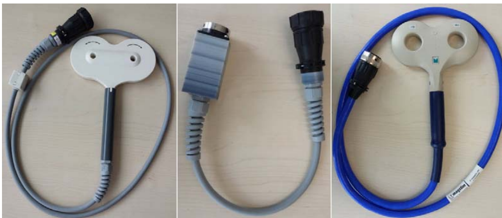
Abbildung 18: Spule von MAG und More (Verwendung Interventionsprotokolle), AP/PA-Switch zur Stromflussumkehr, Spule von Magstim (Verwendung Latenzvermessung I-Wellen) (von links nach rechts)
