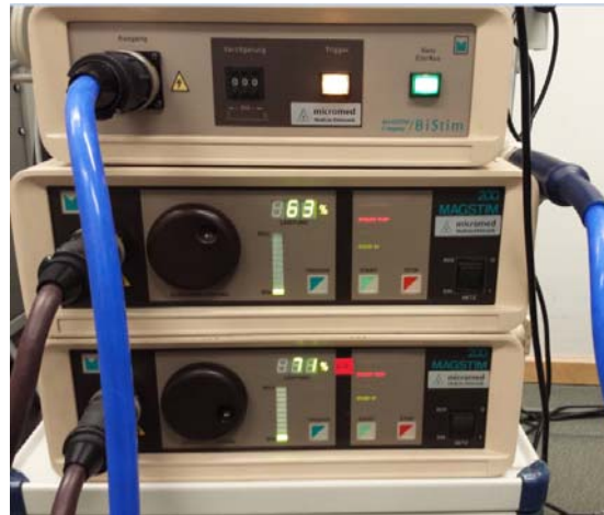
Abbildung 16: Aufbau der Stimulatoren zur I-Wave-Latenzvermessung (gepaarte Stimulation, Short-intercortical facilitation, unten zwei Einzelstimulatoren Magstim 200 mit BiStim-Modul oben)
