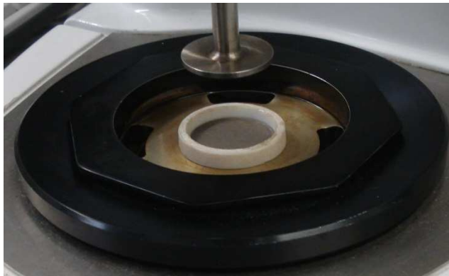
Abbildung 2.8: Für die Prüfung von Asphaltmörtel im DSR entwickelte Stützstruktur in Form eines Teflonringes, der den Probekörper stützt und dessen seitliches Auflösen verhindert.
