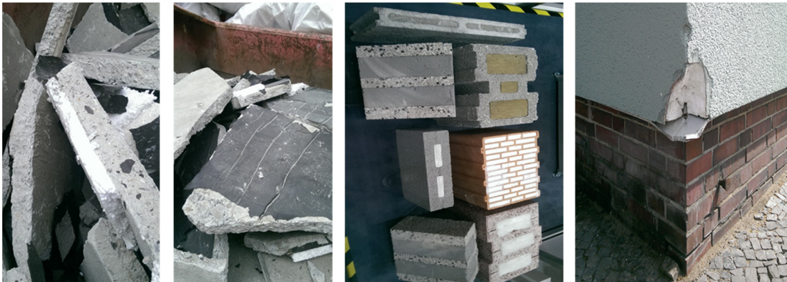
Abbildung 25: Beispiele für Hybridbaustoffe und Materialkombinationen: Herausforderungen in der getrennten Erfassung und Aufbereitung (Eigene Darstellung)
