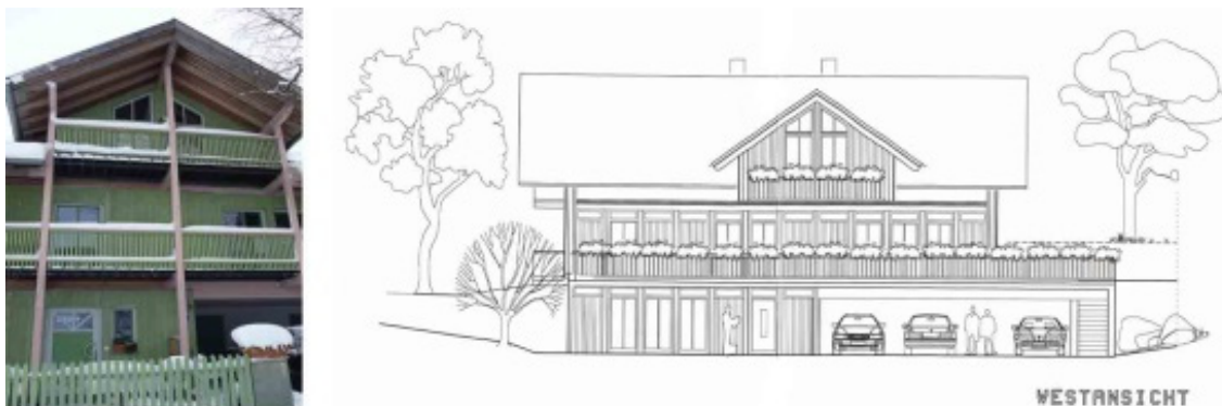
Abbildung 80: EFH Holzständerbauweise (BJ 1996) (Eigenes Bild (links); Plan von Wilhelm Heinrich (rechts))
