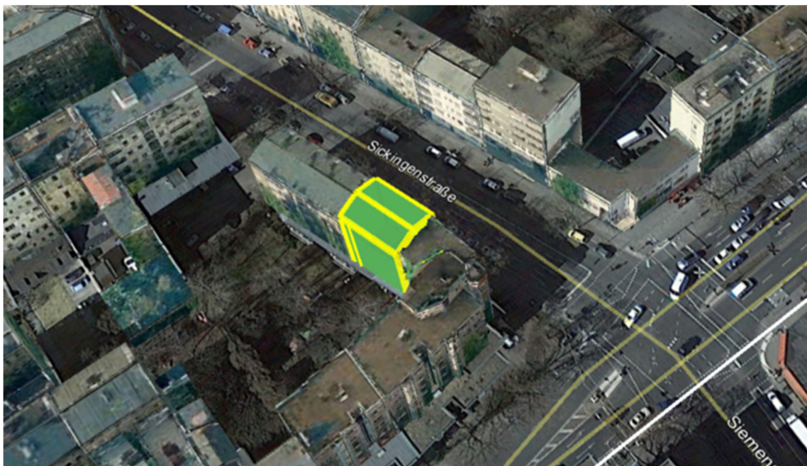
Abbildung 93: Auszug aus einem CityGML Model im 3DCityDB Webclient des Lehrstuhls für Geoinformation mit Erkennung der Gebäudehülle (Mit freundlicher Genehmigung von Thomas Kolbe 2015)
