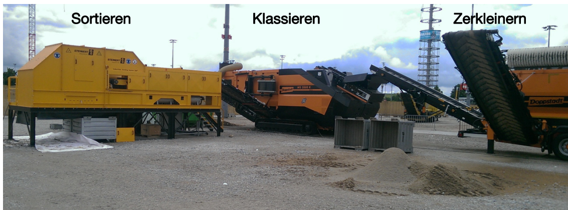
Abbildung 20: Beispiel für Konstellation von mobilen Aufbereitungsanlagen (Eigene Darstellung)
