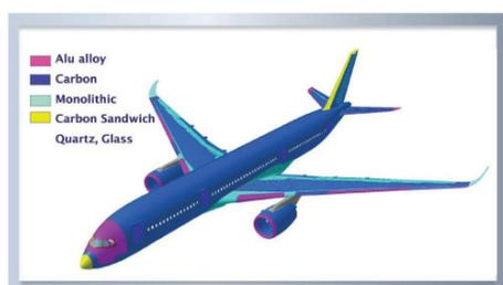
(a) Anteile von Composites an der Struktur des Airbus A350XWB [29]
