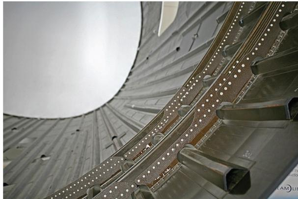
**Abb. 1.3.:** Beispiel der Anwendung von Nietverbindungen bei Rumpfstrukturen an der Boeing 787 [2]
