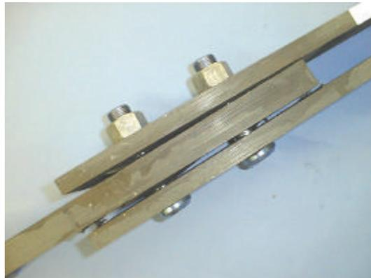
Abb. 2.2.: Bolzenbruch nach dynamischer Belastung [3]
