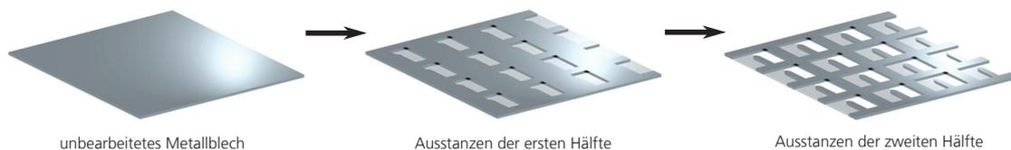
**Abb. 2.31.:** Herstellung der metallischen Verstärkungselemente mittels Stanztechnik
