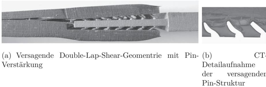
**Abb. 2.25.:** Versagensmechanismus einer mit geraden Pins verstärkten Double-Lap-Shear-Probe [16]
