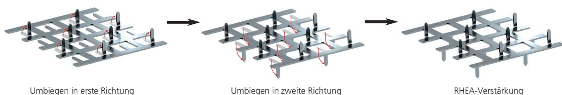
**Abb. 2.33.:** Herstellung der RHEA-Verstärkungselemente mittels Biegung
