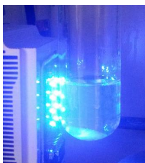
Abbildung 30: Bestrahlung einer Katalyselösung mit acht LEDs des kontinuierlichen 450 nm-LED-Setups.
