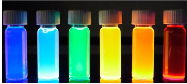
Abbildung 8: In Toluol dispergierte 3-4 nm große SiNP mit unterschiedlichen Oberflächenfunktionalisierungen unter UV-Bestrahlung. Oberflächenfunktionalisierung von links nach rechts: Dodecylamin, Acetal, Diphenylamin, Trioctylphosphinoxid, Dodecan (an Luft), Dodecan (inert). [54]
