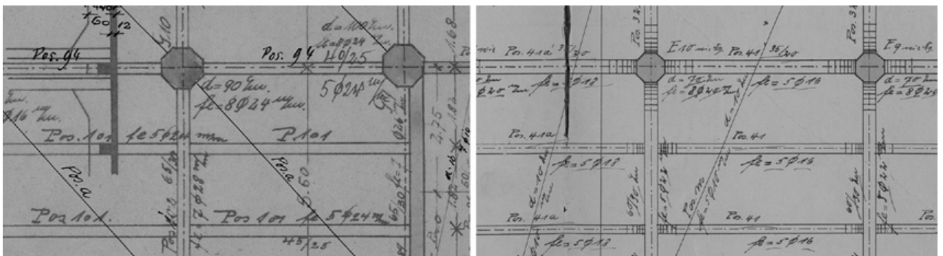
Abb. 268: Positionspläne für Deckenbewehrungen am Lindwurmhof in zwei verschiedenen Geschossen, die als statische Bauvorlagen bei der Genehmigungsbehörde eingereicht wurden. Die Querschnitte der Bauelemente wurden genauso angegeben wie die Anzahl und die Durchmesser der Bewehrungsstäbe. Die Prüfbehörde nahm teilweise in rot Korrekturen vor, die durch die unterschiedliche Handschrift hier ablesbar sind (StadtAM, DE-1992-LBK-19330).
