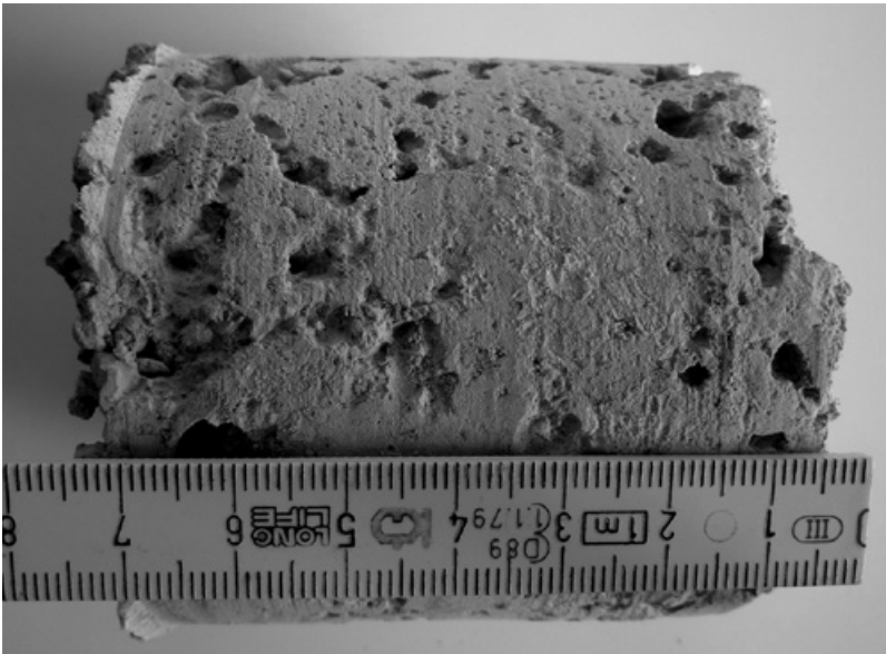
Abb. 321: Deutsches Museum: Ein Bohrkern, der 2017 an einer Vorsatzschale aus Leicht- oder Bimsbeton entnommen wurde (Foto: JR)
