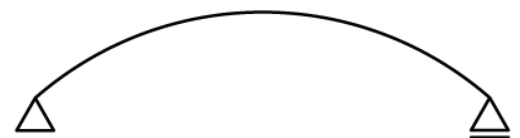
Abb. 89: Statisches System eines Gurtbogens (JR).
