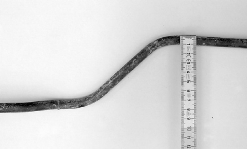
Abb. 25: Verkröpfte Deckenbewehrung, entnommen im Lindwurmhof in München (Foto: JR).
