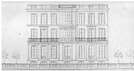
Abb. 205: Wohnhaus in St. Denis 1853 aus Stampfbeton mit ebenen Decken, bestehend aus Doppel-T-Trägern mit Beton vergossen. Architekt: Théodore Lachèze, Bauunternehmer: François Coignet (Collins 1959, Abb. 2).
