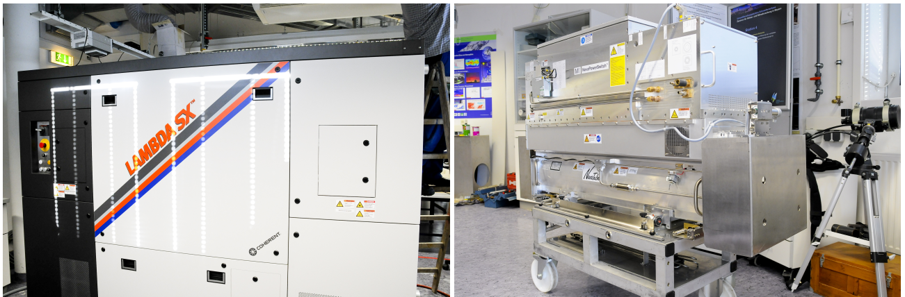
Abb. 20: Links: XeCl-Laser LSX 300C der Firma Coherent, Göttingen. Industrie-Laser mit 350 W Durchschnittsleistung. Rechts: Für den Transport ausgebaute Laser-Röhre im KIT-Labor auf der UFS, in der sich das Laser-Gas befindet (unten) mit Hochspannungseinheit (oben) zur Erzeugung des inertialen Lichtblitzes. (Quelle: Coherent)
