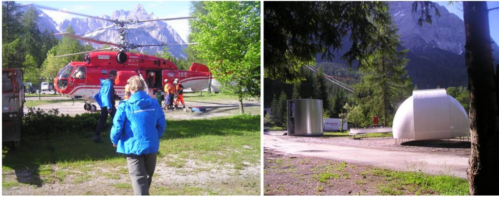
Abb. 31: Links: Der Kamov-Doppelrotorhubschrauber von Heliswiss, mit dem alle Teile des Turmaufbaus zum Schneefernerhaus transportiert wurden, nach seiner Ankunft an der Talstation der Ehrwalder Zugspitzbahn. Rechts: Turmaufbau, Adapterring und Kuppel vor der Talstation der Ehrwalder Zugspitzbahn.
