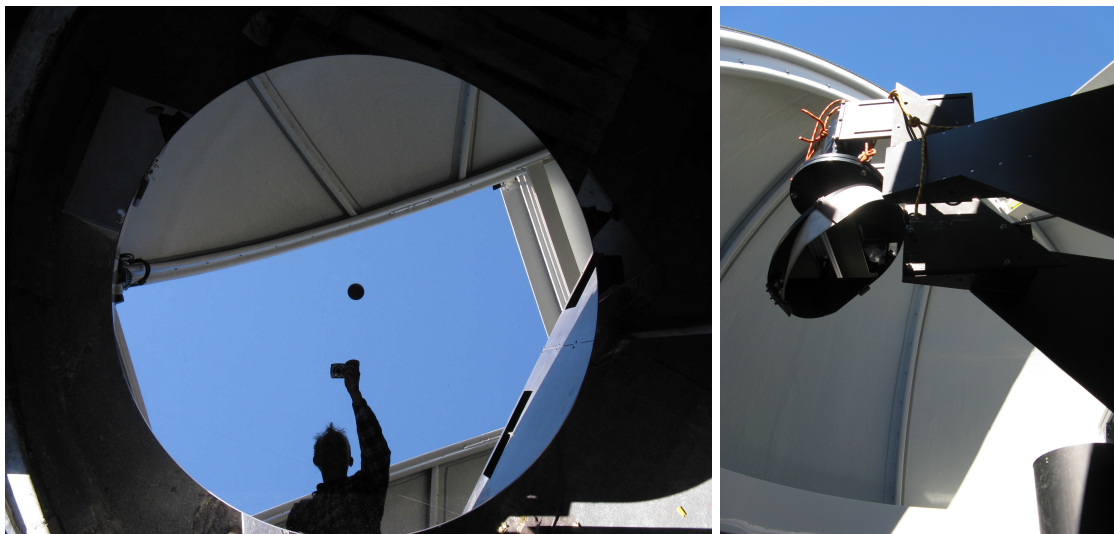
Abb. 36: Links: Empfangsspiegel des Fernbereichsteleskops, Durchmesser 1,5 m, Brennweite 5 m. Auf der Spiegelfläche ist die Kuppelöffnung sowie, als schwarzer Punkt, das Loch im Hauptspiegel zu sehen. Rechts: Newton-Sekundärspiegel des Fernbereichsteleskops mit Halterung.
