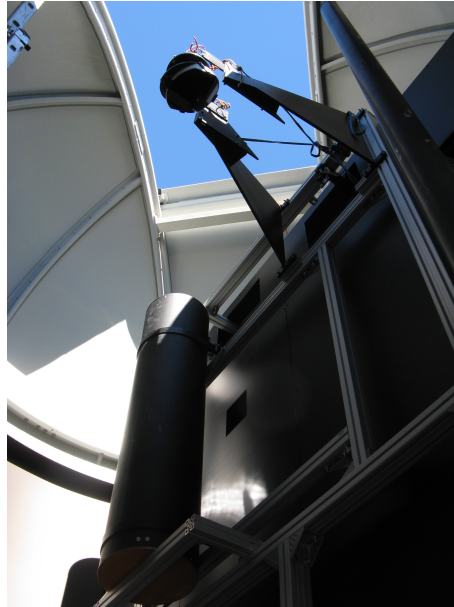
Abb. 37: Oben: Newton-Sekundärspiegel des Fernbereichsteleskops; unten: Nahbereichsteleskop, Durchmesser: 0,36 m, Brennweite: 1,90 m. Beide sind an einem vom Turm mechanisch entkoppelten Strebengerüst montiert.
