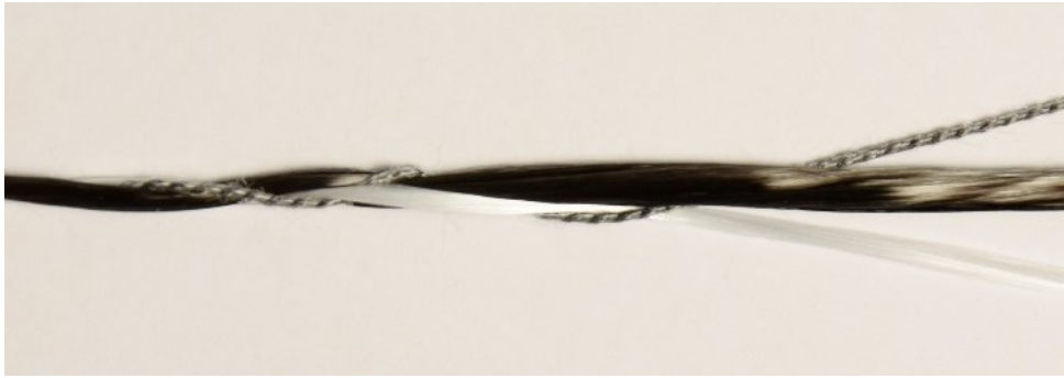
Abb. 2-5: Manuell hergestellte Litze aus einem Kohlenstofffaser-, Glasfaser- und Commingled-Garn
