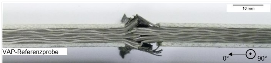
Abb. A-10: Repräsentatives Bruchbild einer VAP-Referenzdruckprobe
