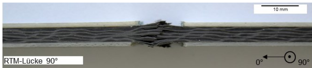
Abb. A-14: Repräsentatives Bruchbild einer RTM-Lücke 90°-Druckprobe
