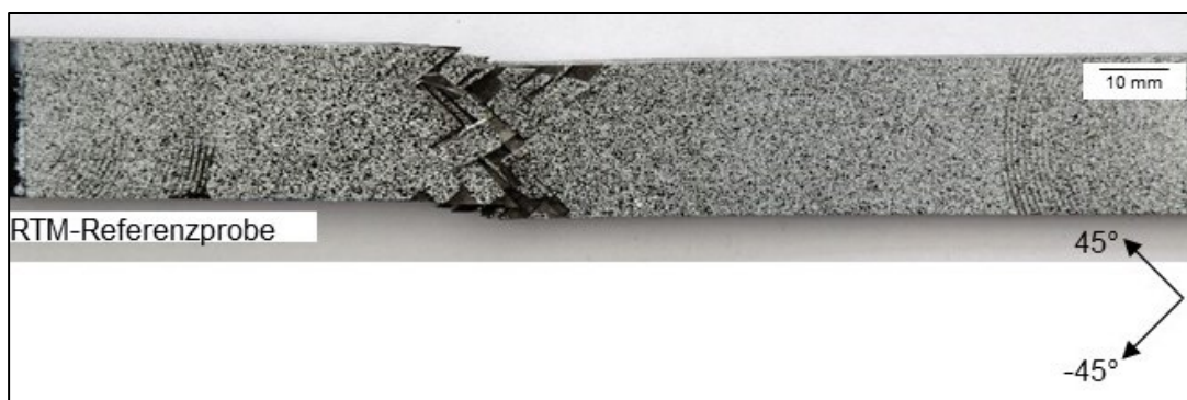
Abb. A-18: Repräsentatives Bruchbild einer RTM-Referenzschubprobe
