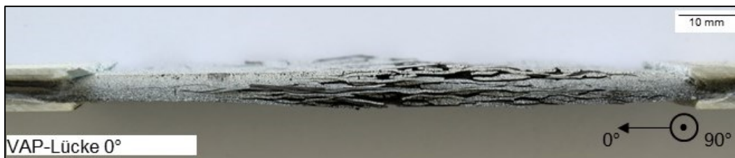
Abb. A-2: Repräsentatives Bruchbild einer VAP-Lücke 0°-Zugprobe
