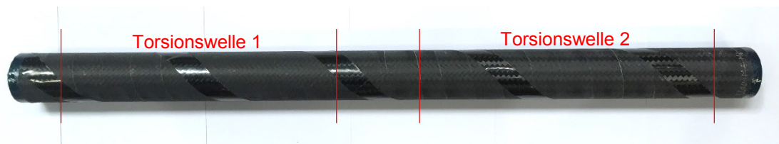
Abb. 7-10: Fertiger Rohling aus dem zwei Torsionswellen entnommen werden. Hergestellt im modifizierten VAP-Verfahren
