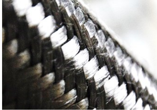
Abb. 2-12: Global abstehende Filamentfragmente eines mit zu hoher Garnspannung hergestellten Geflechts
