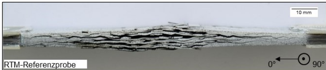
Abb. A-4: Repräsentatives Bruchbild einer RTM-Referenzzugprobe
