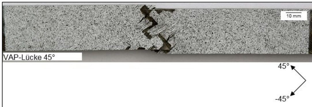
Abb. A-17: Repräsentatives Bruchbild einer VAP-Lücke 45°-Schubprobe
