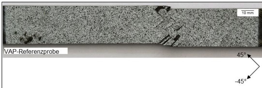
Abb. A-16: Repräsentatives Bruchbild einer VAP-Referenzschubprobe
