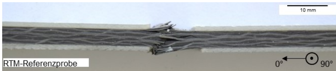
Abb. A-13: Repräsentatives Bruchbild einer RTM-Referenzdruckprobe
