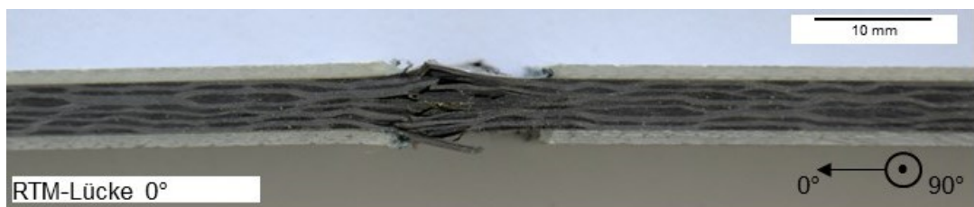
Abb. A-15: Repräsentatives Bruchbild einer RTM-Lücke 0°-Druckprobe
