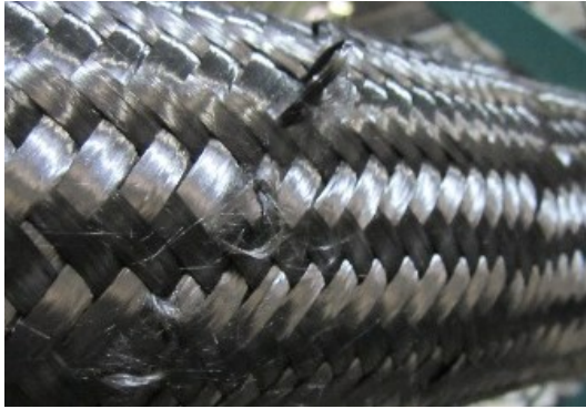
Abb. 2-14: Garnschleife eines Biaxialgeflechts (aus [20])
