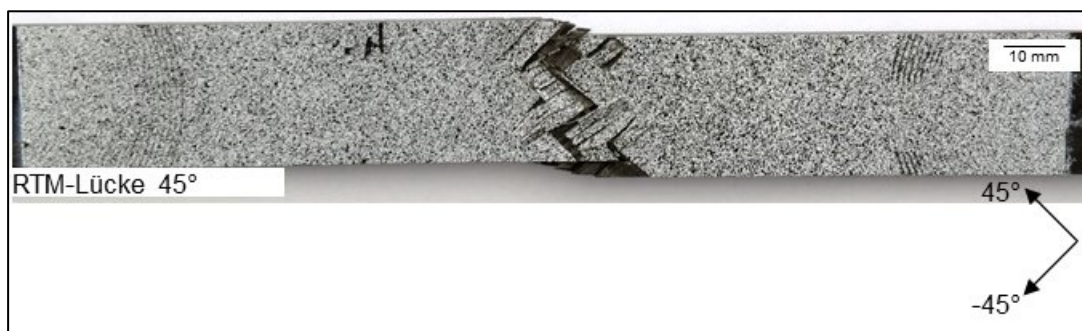
Abb. A-19: Repräsentatives Bruchbild einer RTM-Lücke 45°-Schubprobe
