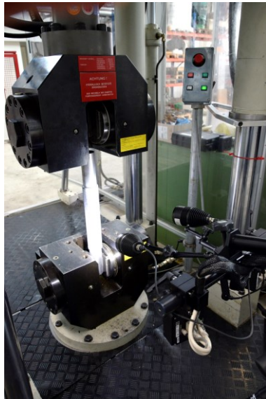
Abb. 7-15: Messaufbau an der Torsionsprüfmaschine
