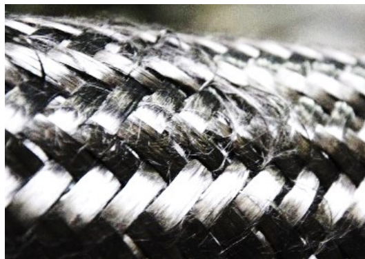
Abb. 2-13: Lokale Filamentansammlung an einem Biaxialgeflecht
