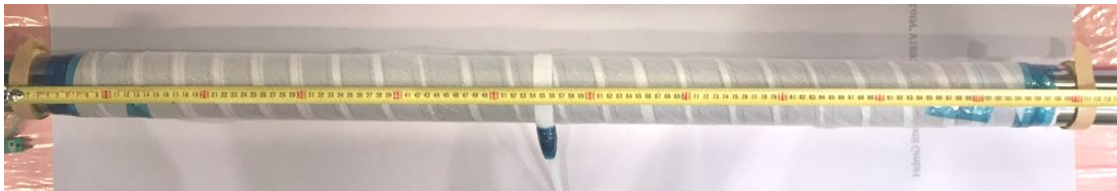
Abb. 7-8: Abreißband umwickelt um Geflechtpreform und Druckblech
