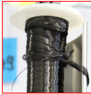
Abb. 4-21: Detailaufnahme von FR 1 der Versuchsspule n49 Bei einer Abzugslänge von 35 m
