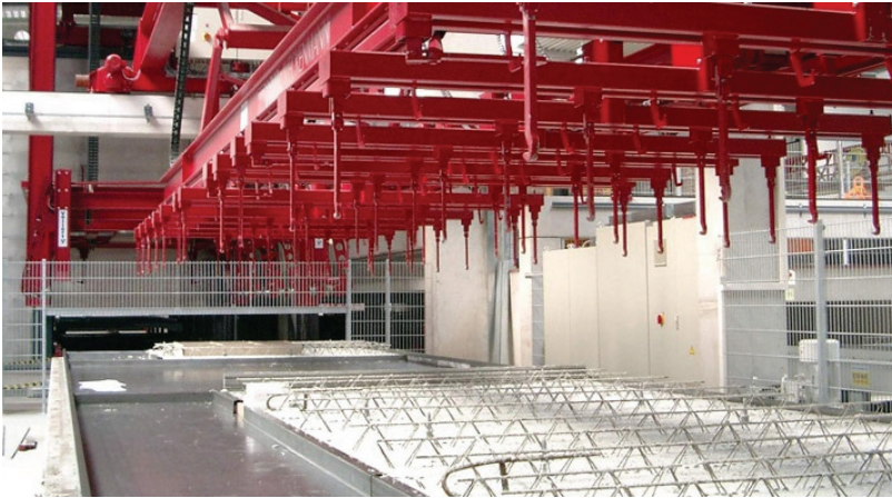
Fig. G.24: Automated lifting truss (Weckenmann Anlagentechnik GmbH+Co. KG, 2006)
