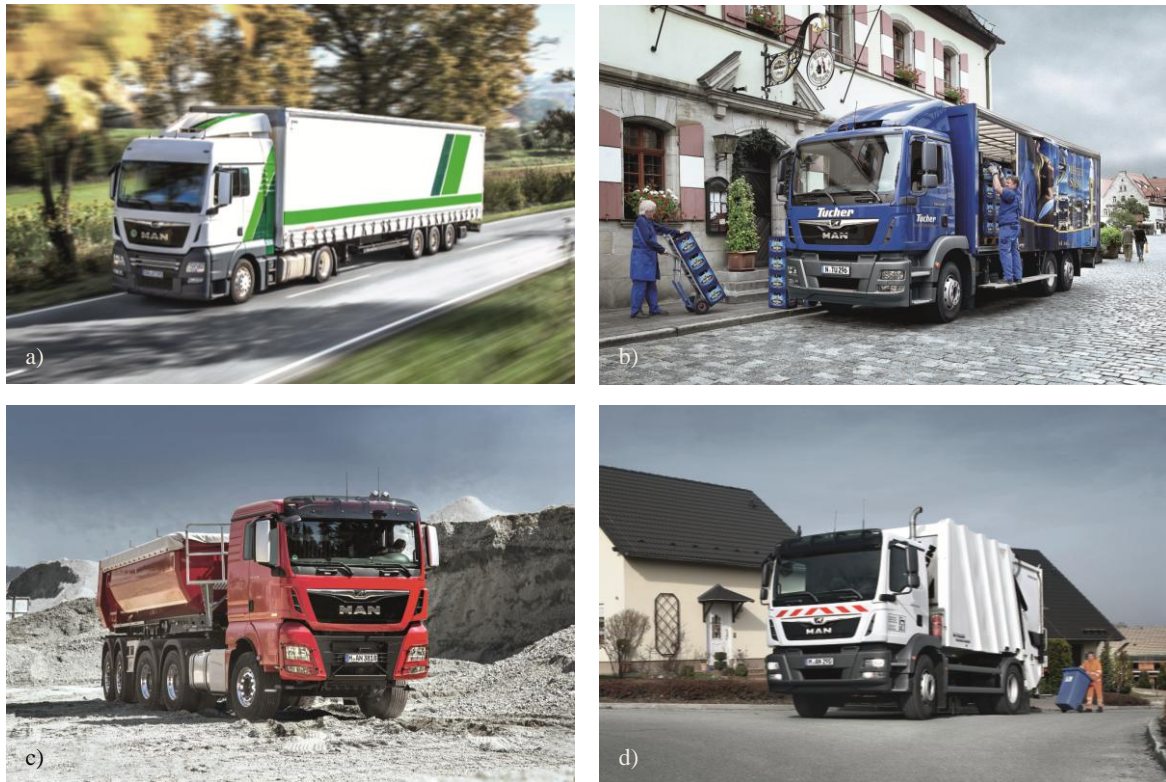
Abbildung 4-1: Bedingt durch die unterschiedlichen Einsatzsegmente sind die Ausprägungen der Fahrzeugtypen und Transportlösungen vielfältig: a) Sattelzug mit Planenaufleger im Fernverkehr; b) Pritschenfahrzeug mit Planengestell im Verteilerverkehr; c) Schwerer Muldenkipper im Baustellenverkehr; d) Sonderfahrzeug (hier: Abfallsammelfahrzeug) mit individuellem Aufbau (Bilder zur Verfügung gestellt durch die MAN Truck & Bus AG. Alle Rechte vorbehalten.)
