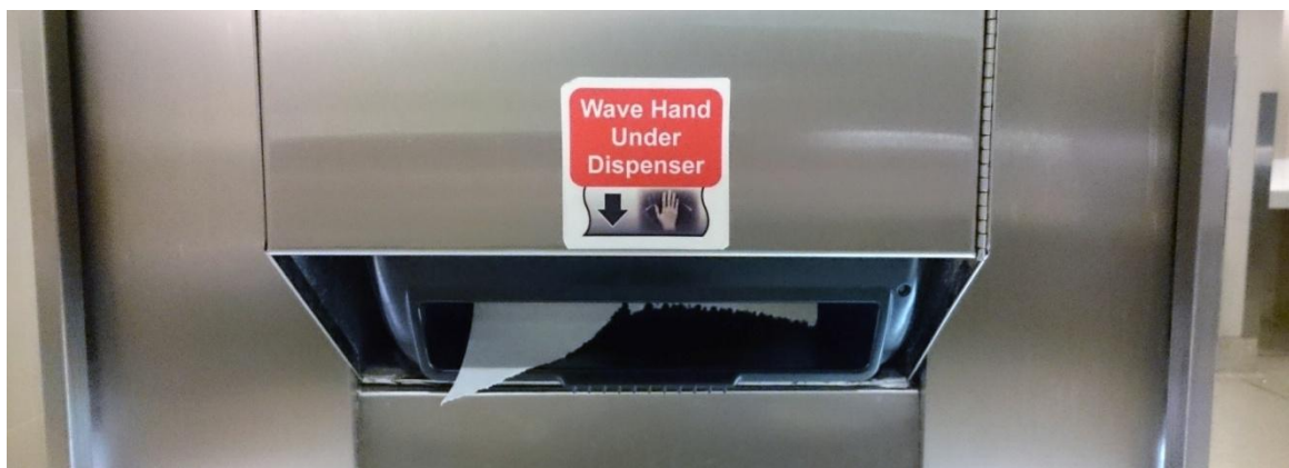
Abbildung 5-3: Einsatz eines Signifier bei einem Papierhandtuchspender, der per Gestik bedient wird. Anhand des Aufklebers ( Signifier ) weiß der Nutzer, wo und wie er seine Hand bewegen muss, um ein Papierhandtuch zu erhalten. Ohne den Aufkleber könnte der Nutzer die Affordance des Papierhandtuchspenders leicht fehlinterpretieren. Er würde wohl am Papierhandtuch selbst ziehen – schließlich wären zunächst keine sonstigen Interaktionsmöglichkeiten sichtbar.
