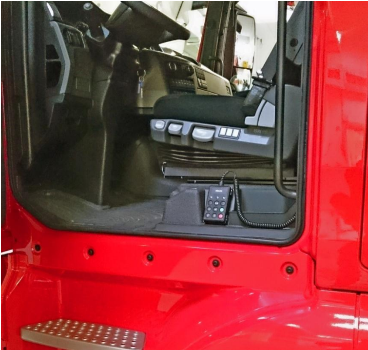
Abbildung A-1: Anbringung des ECAS-Bedienmoduls im Fahrerhaus. Das ECAS-Bedienmodul ist herausnehmbar.
