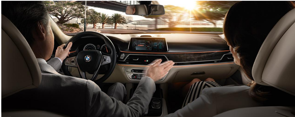
Abbildung 3-5: Durch verschiedene Gesten wie „Zeigen“ oder „Wischen“ bedient der Fahrer diverse Fahrzeugfunktionen berührungsfrei. Die zur Verfügung stehenden Interaktionsmöglichkeiten werden dem Fahrer via Display dargestellt. (Bildquelle: BMW AG, 2015)
