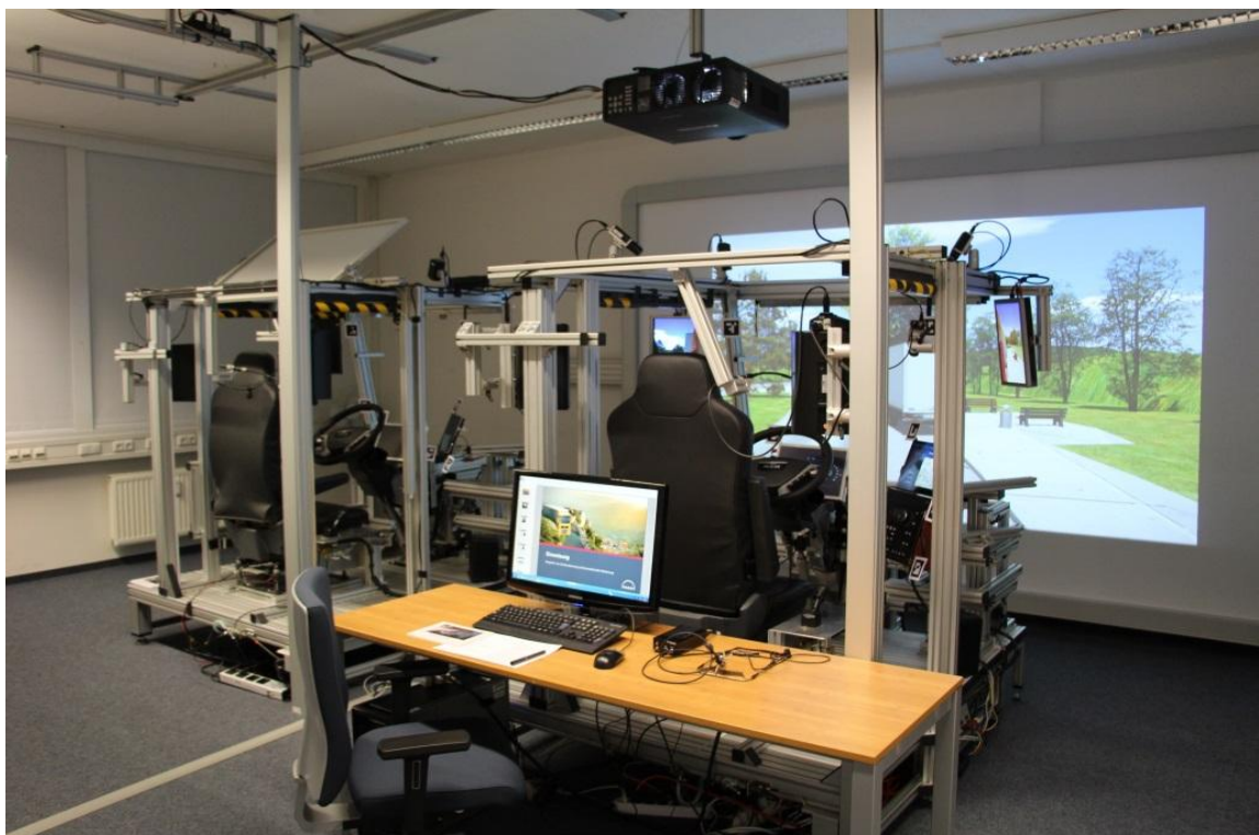
Abbildung 6-3: Vergleichsprüfstand, bestehend aus zwei einzelnen Fahrerhaus-Mockups. Durch Verschieben von Leinwand und Projektor kann die Fahrsimulation zwischen den beiden Mockups verfahren werden. Während das eine Mockup als Fahrerkabine mit Gestensteuerung aufgebaut ist, umfasst das andere Mockup alle für die konventionelle Bedienung relevanten Bedienelemente.
