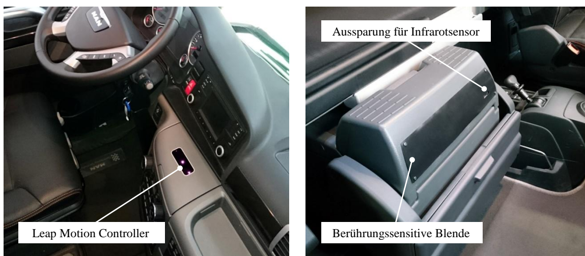
Abbildung 6-12: Für die Erkennung der Gesten zur Steuerung des Sonnenrollos und der Leselampe wird rechts vom Lenkrad ein Leap Motion Controller am Armaturenbrett montiert (links). Zur Steuerung der Kühlbox dienen hingegen ein Infrarotsensor sowie eine berührungssensitive Blende, die an der Vorderseite der Kühlbox angebracht sind (rechts).
