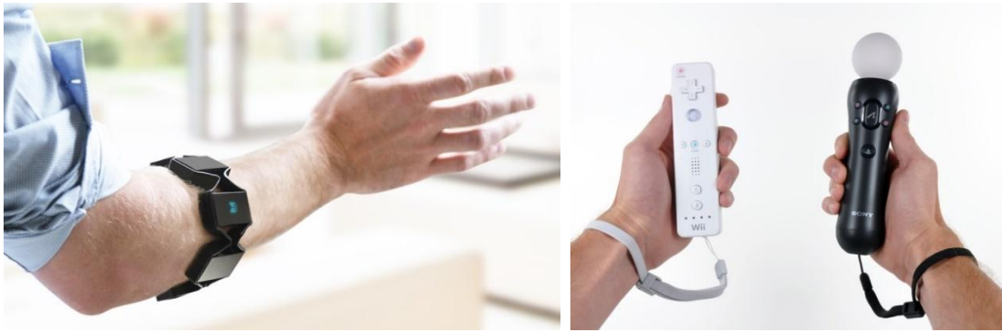
Abbildung 2-1: Beispiele für die intrusive Gestenerkennung: das Armband Myo von Thalmic Labs Inc. (links) und die handgehaltenen Controller der Nintendo Wii und der Sony PlayStation (rechts). (Bildquellen: Smith, 2014; Newsom, 2010)
