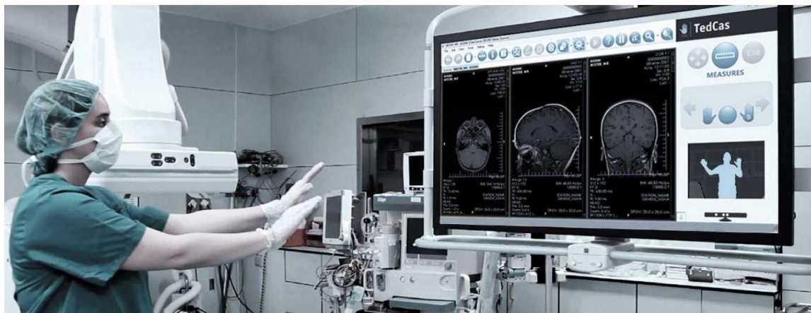
Abbildung 3-3: Ohne den sterilen Bereich verlassen zu müssen, kann ein Arzt Bildschirminhalte per Gestik manipulieren. Die Interaktion erfordert kein Desinfizieren, wodurch Zeit und Kosten gespart werden. (Bildquelle: TedCas Medical Systems, 2017)
