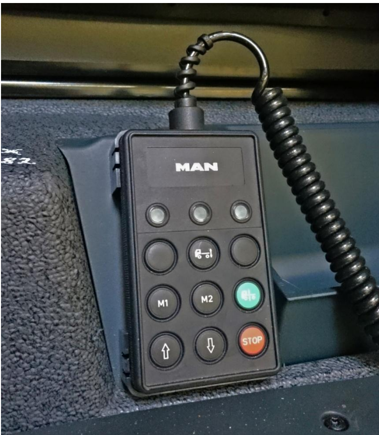
Abbildung A-2: Eingabemöglichkeiten am ECAS-Bedienmodul zur Steuerung der Luftfederung
