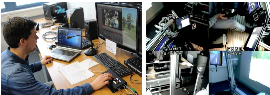
Abbildung 6-2: Der Wizard steuert eine Funktion mittels Bedienkonsole (links) auf Grundlage der auf dem Kamerabild zu erkennenden Geste (rechts). Insgesamt wurden vier Kameras eingesetzt, wobei jede Kamera einer bestimmten Geste zugeordnet und so im Fahrsimulator positioniert wurde, dass die betreffende Geste optimal zu erkennen war.
