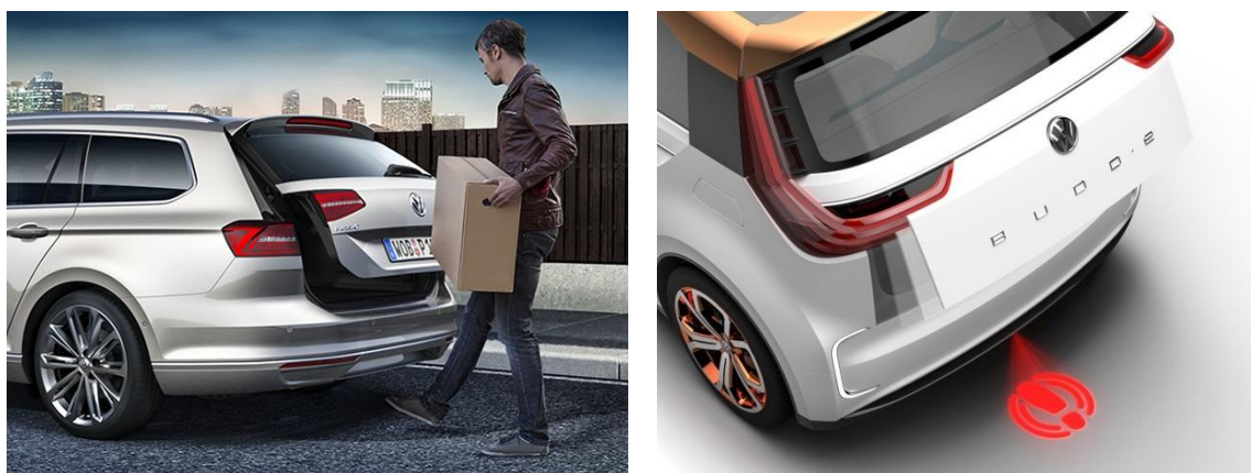
Abbildung 3-4: Beim VW Passat erlaubt ein gezielter „Kick“ des Nutzers das automatische Öffnen der Kofferraumklappe (links). Bei einer Weiterentwicklung des Systems deutet ein Lichtmuster dem Nutzer an, wo er seinen Fuß platzieren muss, um den Kofferraum zu öffnen (rechts). (Bildquellen: Volkswagen AG, 2017b; Volkswagen AG, 2017c)
