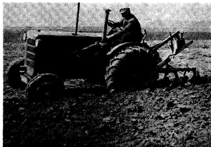
Abb. 2: Einer der ersten Nachkriegs-Schlepper, bereits mit Anbau-Pflug ausgestattet
