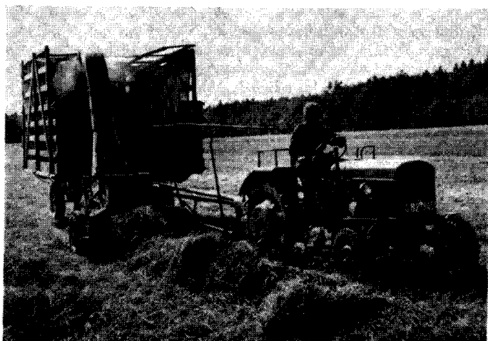
Abb. 13: Eines der jüngsten Kinder der landtechnischen Entwicklung ist der Feldhäcksler, dessen Verwendung entsprechende Ladegatter am Wagen bedingt
