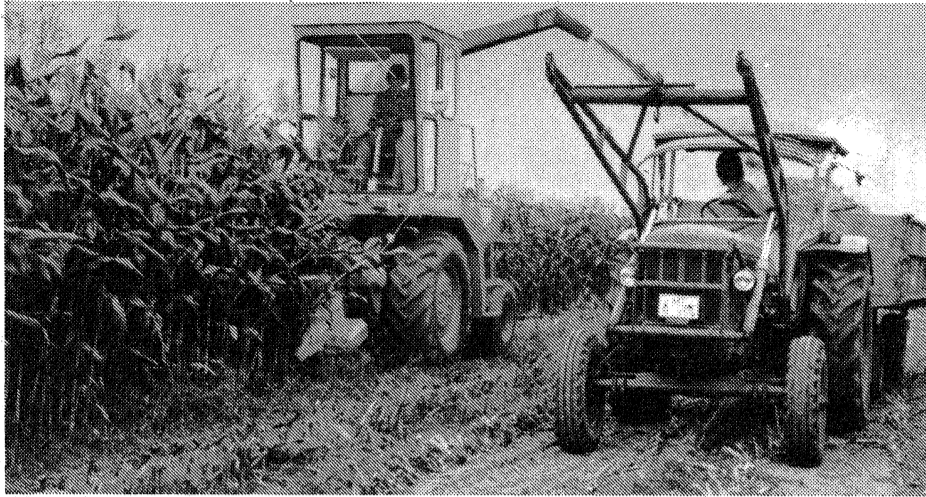
Selbstfahrender Maishäcksler beim Einsatz im Parallelbetrieb.
