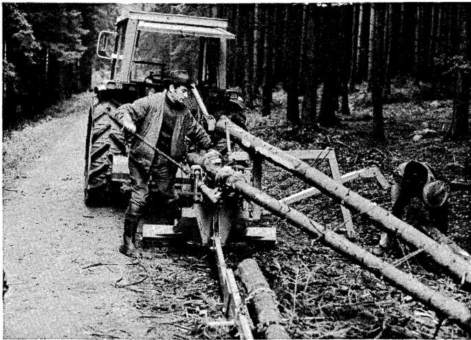
Abb. 7: Salemer Astfix SAF 20 zum Entasten, Streifen und Ablegen von Schwachholz
