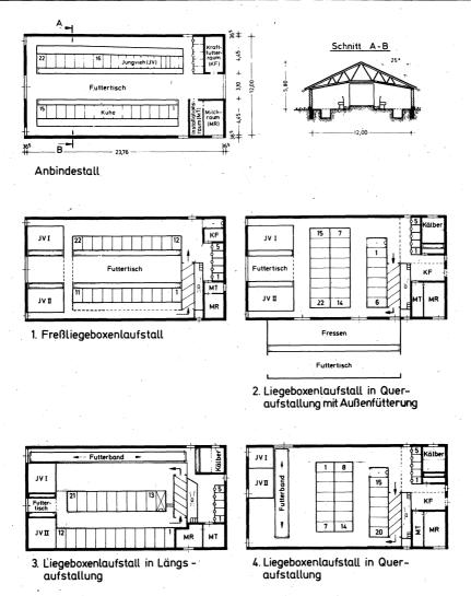
Abb. 13: Umbaulösungen für einen bestehenden Anbindestall mit 20 Kühen und Nachzucht
