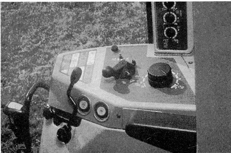
DIE EHR-BEDIENPULTE sind mittlerweile aufgelöst. Nur noch die Betätigungselemente für heben/senken und für die Tiefeneinstellung befinden sich in unmittelbarer Fahrernähe. Fotos: Auernhammer
