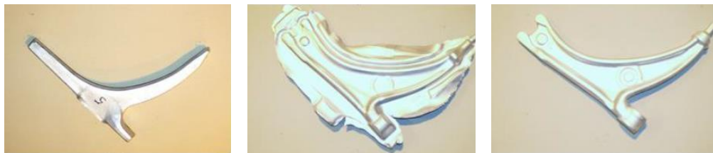
Gusszustand → nach dritter Umformstufe → Fertigteil
