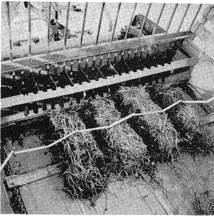
**Bild 6: Schneidvorrichtung mit bewegten Messern von Wagen (2)**
