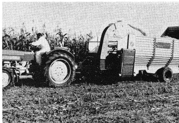
Abb. 2: Schlepper und Ladewagen bilden eine kurze und wendige Einheit und erfordern normalerweise kein Umhängen. Diese Vorteile hat auch der abgebildete Häckseladewagen. Das Ladegut ist aber hier bereits gehäckselt und kann ohne Dosiereinrichtung vollmechanisch einem Gebläse oder Förderband zugeführt werden. Mit dieser Arbeitskette läßt sich bis zu einer Futterfläche von etwa 20 ha die Futter- und Strohernte mit dem geringsten Kapitalaufwand voll mechanisieren
