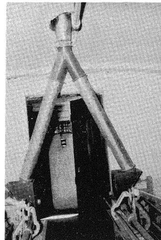
Bild 12: Der Zulauf aller Futtermischungen aus den drei Vorratsbehältern vom Dachraum zum Stall erfolgt auf direktem Weg über Fallrohre.
