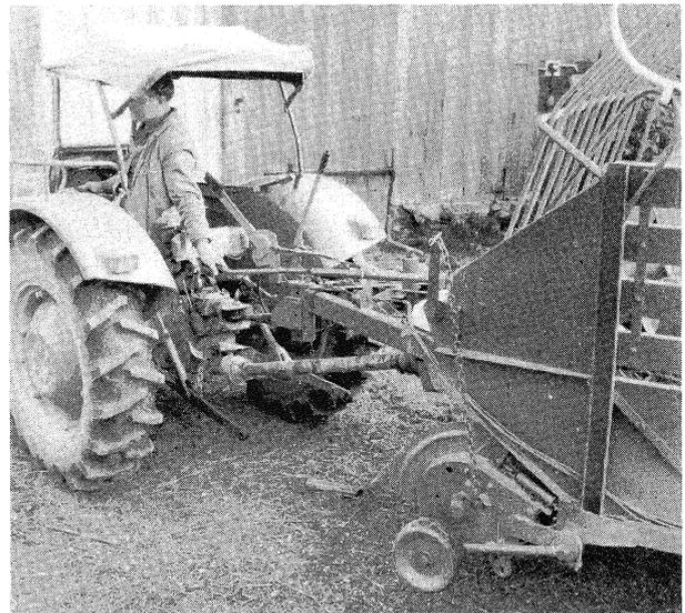
Abb. 5: Eine günstige Anordnung der Hebel an der Ladewagendeichsel trägt wesentlich zur Arbeitserleichterung und Unfallverhütung bei
