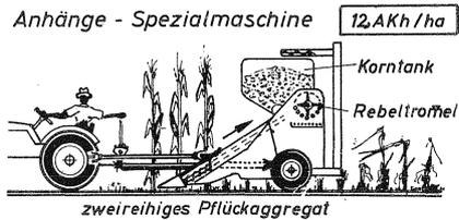
Abb. 1: Pflückrebler auf Unimog oder rückwärts fahrendem Geräteträger sowie angehängte zweireihige Maschine für Großbetriebe. Hersteller: Eicher-Geringhoff, Unimog-Geringhoff, Rivierre-Casalis.
