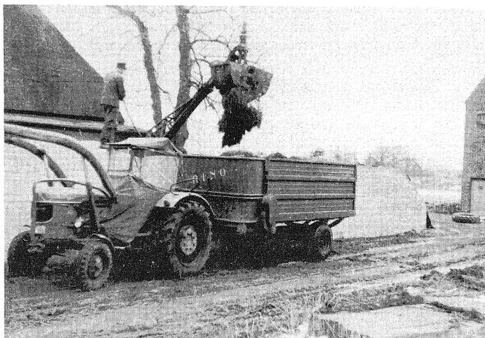
Abb. 6: Dieser Einachsanhänger in Ganzstahlausführung dient als Futterverteilwagen. Zum Stallmiststreuen wird der ganze Aufbau über den Rahmen um 180° geschwenkt (Drehpunkt-Halbbügel vor der Achse), das Austragförderband wird abgebaut und durch Streuwalzen ersetzt. An der Vorder- und Rückseite des Wagens ist dazu ein Zapfwellenstummel vorhanden
