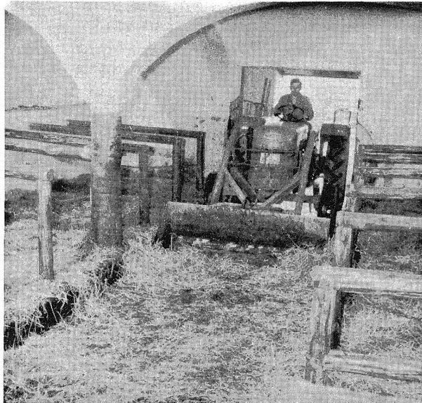
Abb. 6: Entmisten mit Frontlader, der mit breiter Kotgangschaukel ausgerüstet ist.
