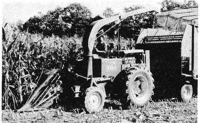
Abb. 5: Selbstfahrender Feldhäckslers mit zweireihigem Maisgebiß. Messer sind aus Verbundmaterial hergestellt.
