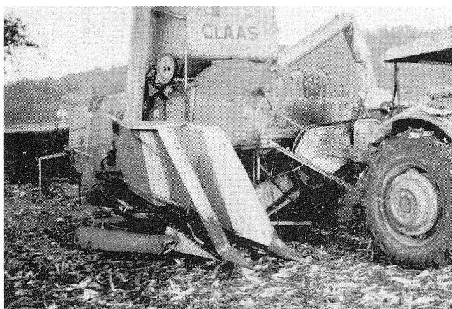
Abb. 3: Der gezogene Mährescher wird mit einem kurzen Mähmähtisch und einreihigem Maisschneidwerk ausgerüstet. Der Antrieb der Zuführketten geschieht über das Mährescher-Laufrad, also abhängig von der Fahrgeschwindigkeit
