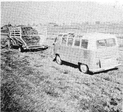
Bild 13: Meßwagen mit Drehmoment-Registrieranlage im Schlepp des zu untersuchenden Ladewagens
