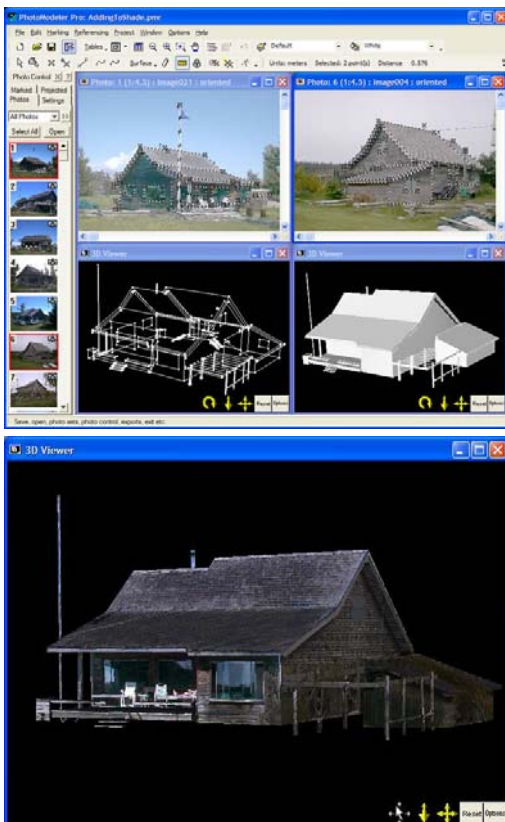
Abb. 2: Mehrbild- Photogrammetrie: Kanten- und Flächenmodell, oben und texturiertes Flächenmodell, unten [2]
