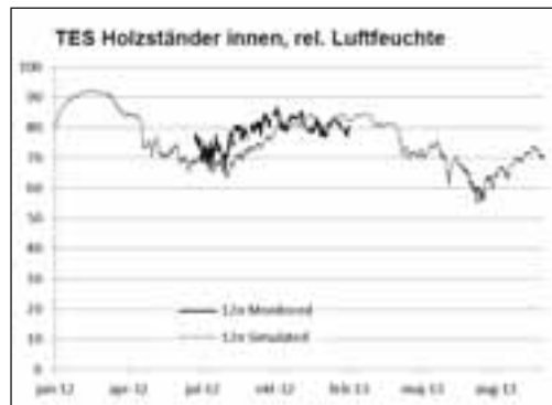
Abb. 5: Temperatur und relative Luftfeuchtigkeit für die Münchner TES Fassadenelemente, Holzständer (12n).
