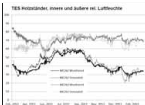
Abb. 7: Temperatur und relative Luftfeuchtigkeit für die Oulu TES Fassadenelemente Holzständer, Innen (TE / ME262) und äußeren (TE / ME263) Position.
