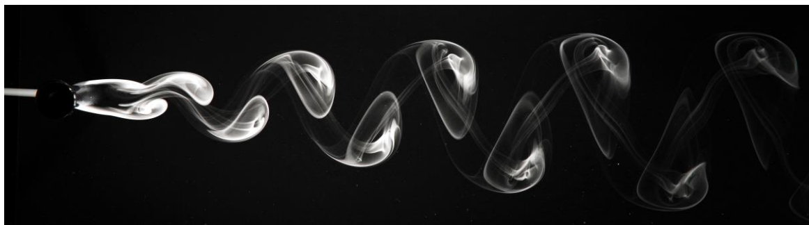
Abbildung 21: Visualisierung der Karmannschen Wirbelstrasse von Jürgen Wagner (CC BY 4.0 DE)
