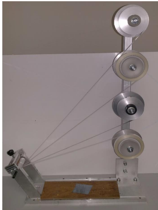
Abbildung 15: Vorrichtung zum manuellen Fertigen von mehrlagigen PVDF-Wickeln [78]
