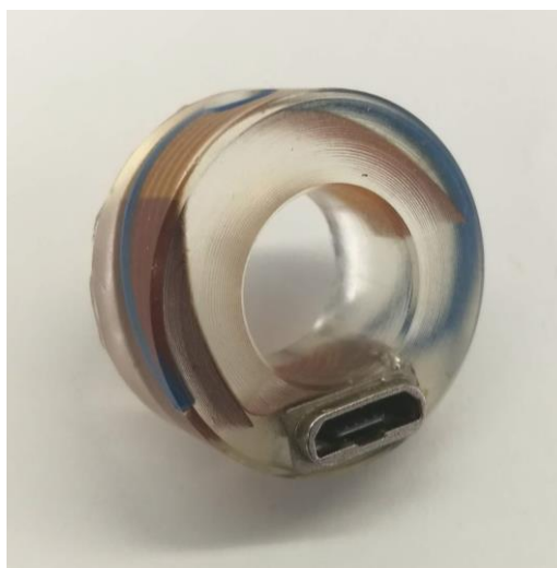
Abbildung 37: Störkörper aus Gießharz mit flexibler Leiterplatte und Micro-USB-Schnittstelle
