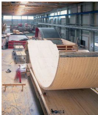
Abb. 113: Gekrümmte Brettsper Holzplatte der Aussegnungshalle Gräfelfing [Winter, et al., 2008]
