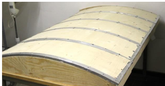
Abb. 249: Probekörper mit Aluminiumabklebung
