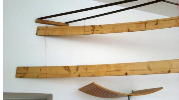
Abb. 230: Lagerung der Lamellen im Büroraum und Lagerungsbedingungen an der Wand (Festpunkt)
