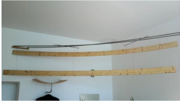
Abb. 230: Lagerung der Lamellen im Büroraum und Lagerungsbedingungen an der Wand (Festpunkt)
