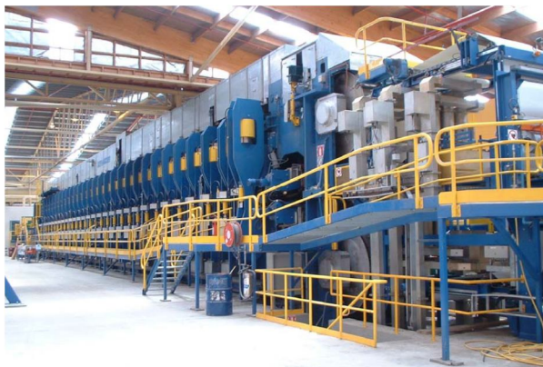
Abb. 112: Produktionsstraße für Dreischichtplatten [www.dieffenbacher.de]
