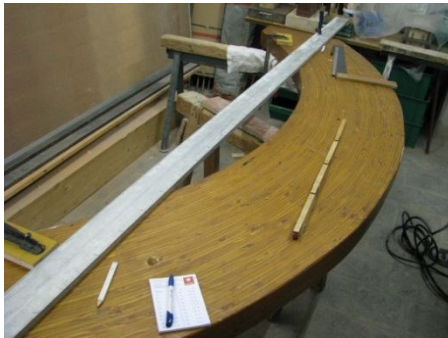
Abb. 216: Richtlatte zur Vermessung
