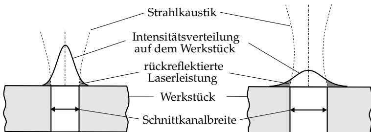
Abbildung 3.9: Fokussierter (links) und defokussierter (rechts) Laserstrahl-Schneidprozess; durch die Strahlaufweitung bei Defokussierung ändern sich die Schnittkanalbreite und die rückreflektierte Laserleistung; nach SCHINDHELM ET AL. (2013)
