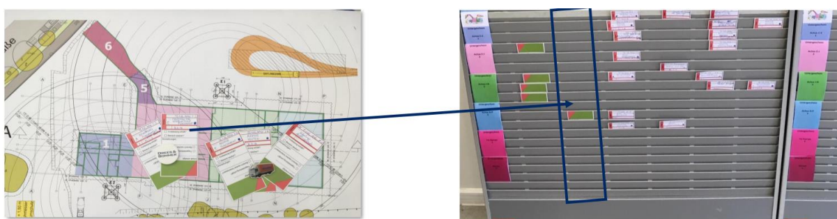
Abbildung 3.4.3-5: Erledigte Plankarte vom Grundrissplan zurück in die Tafelplanung gesteckt (erledigt → grüne Seite nach oben) (Drees & Sommer 2019)
