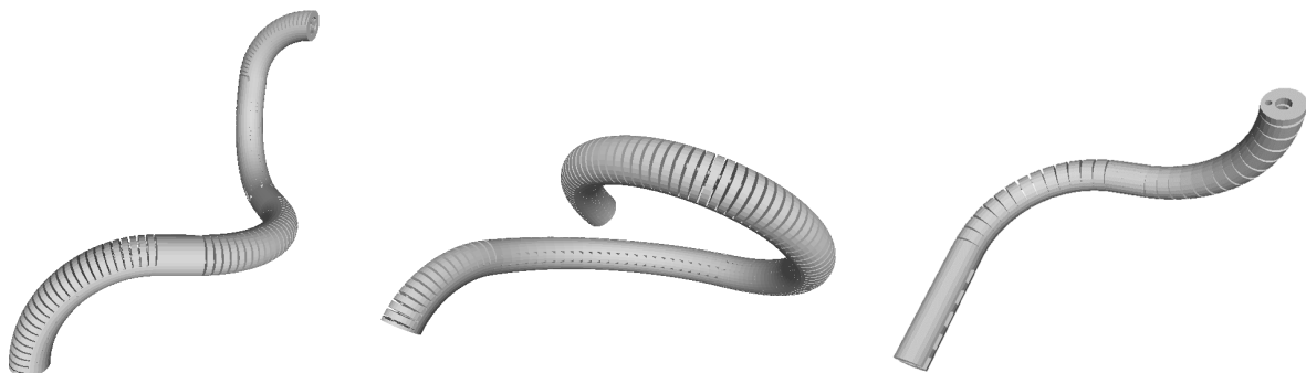
Abbildung 7.46: Beispiele von Shape-Memory Strukturen mit unterschiedlichen Endposen
