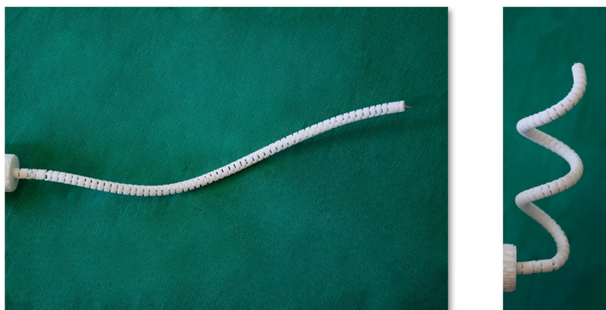
Abbildung 7.60: Anwendungsbeispiel einer selektiv lasergesinterten Shape-Memory Struktur mit flexiblem Ausgangszustand (links) und einer vorgegebenen Endpose in Spiralform (rechts)
