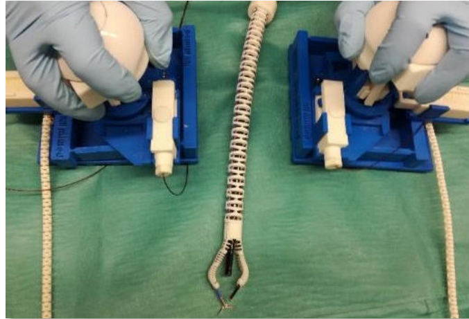
Abbildung 7.90: Endoskopischer zweiarmiger SPOT Manipulator für ein 6 mm-Gastroskop
