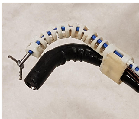
Abbildung 7.92: SPOT Systemvariante „behind-tip-mounted“ nach dem ex-vivo Experiment. Der Manipulatorarm kann der Auslenkung der Endoskopspitze nur bis zu einem Grenzwinkel folgen
