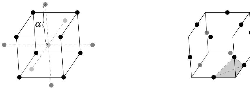
Abbildung 2.4: Schematische Darstellung des CCD (links) und des Box-Behnken-Designs (rechts) für jeweils drei Faktoren mit dem Zentralpunktfaktor \alpha (links)
