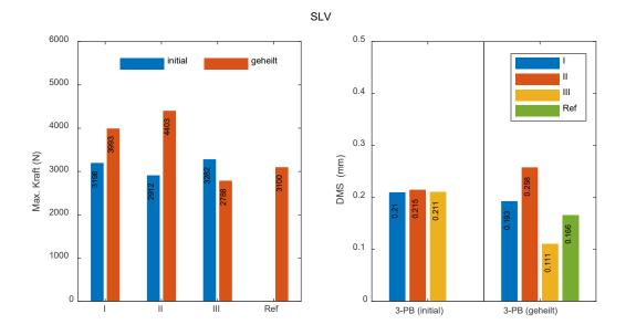
Abbildung 5-6: Maximale Belastungs- und Rissöffnungswerte für "SLV"-Mörteltestkörper für initialen 3-Punkt-Biegeversuch (=Anfangsbelastung) und vier Tage nach der Selbstheilung /Aushärtung (=Wiederbelastung).
