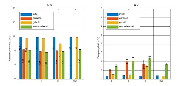
Abbildung 5-27: Resonanzfrequenzen und Dämpfungsfaktor für Mörteltestkörper mit manueller PU-basierter Heilung (SLV) für longitudinale Schwingungsanregung.
