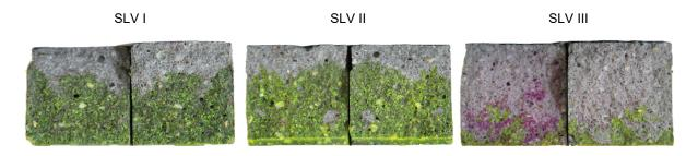
Abbildung 5-5: Querschnittsbilder der "SLV"-Mörteltestprüfkörper nach beendeter Versuchdurchführung. Die fluoreszierende Benetzung dient als Indikator für die Polyurethanverteilung nach einer manuellen Verfüllung.
