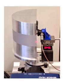
Abbildung 4-15: Bemessung der winkelabhängigen Amplituden- und Ersteinsatzverteilung (1-Grad-Schritt) eines mit Heißkleber angebrachten SE-Gebersensors "Panametrics V103-RB" an einem Aluminiumhalbzylinder mit 1 MHz-Sinusimpuls. Empfänger ist ein Laser-Doppler-Vibrometer (OFV-5000/OFV 505/DD-300, Polytec). Die Werte sind auf einen rechtwinkligen Einfall bei 0°normiert.
