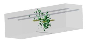
Video 1: 4D-Darstellung der SEA von MEYCO III während der Wiederbelastung durch einen rissweitengesteuerten 3-P-Biegeversuch (vgl. Abbildung 6-14). Die Video-Wiedergabe erfolgt in 20-facher Geschwindigkeit.
