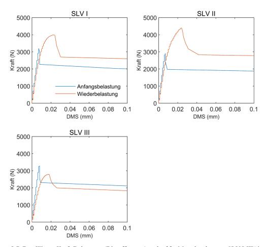
Abbildung 5-7: Detaillierter Kraft-Dehnungs- (Rissöffnungs-) verlauf für Mörteltestkörper "SLV I-III" im Bereich von 0,0 bis 0,1 mm nach manueller Verfüllung.
