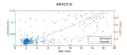
Abbildung 0-11: Zeitabhängiges SE-Auftreten mit entsprechenden Lokalisierungsergbnisse in z-Achse für "MEYCO IV".
