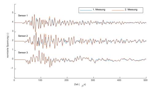
Abbildung 4-11: Ultraschalltransmissionsmessung mit KRNBB-PC-Sensoren an Mörteltestkörper zum Test der Reproduzierbarkeit (Impulsanregung: 2μs-Puls, Abtastrate: 20 MHz, Betrachtete Signallänge: 500 μs).
