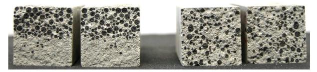
Abbildung 5-8: Querschnitt von Mörtelprismen mit eingebrachten Liapor-Ton-Kugeln. Links: Resultat der Verteilung der Tonkugeln bei Verfüllung der Prismenschalung in einem Arbeitsgang und anschließender Verdichtung. Rechts: Homogene Verteilung, bedingt durch Verfüllung und Verdichtung der Mischung in zwei getrennten Abschnitten.
