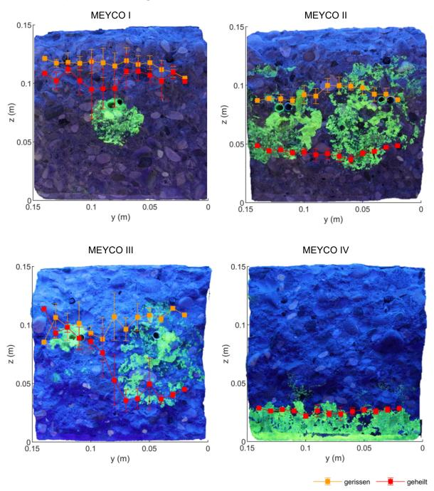
Abbildung 6-9: Risstiefenbestimmung für "MEYCO"-Betontestkörper mit dem ToFD-Verfahren (tomographischer Ansatz) nach der Rissinitiierung sowie nach der Heilungsphase. Zur besseren Übersicht sind die jeweils 13 Messpunkte je Querschnitt miteinander verbunden dargestellt.
