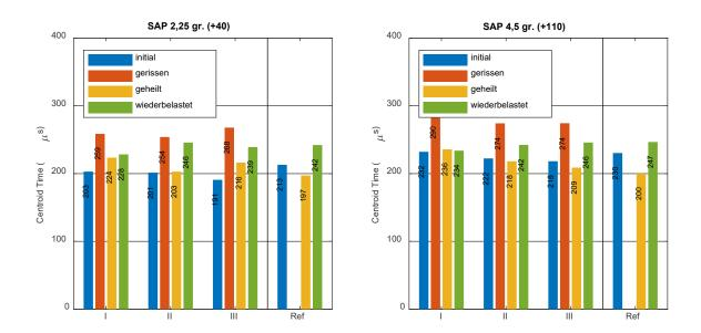
Abbildung 5-23: Centroid Times für Mörteltestkörper mit 2,5 gr. Hydrogelgranulat (links) plus 40 gr. Extrawasser und 4,5 gr. Hydrogelgranulat (links) mit 110 gr. Extrawasser bei 2µs-Einzelimpulsanregung, berechnet für Empfänger E2.
