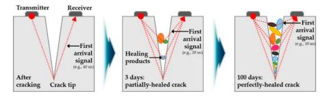
Abbildung 4-3: schemenhafte Darstellung variierender Ultraschalllaufwege während verschiedener Selbstheilungsstadien [Ahn et al. 2017].
