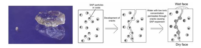
Abbildung 2-2: links: Exemplarische Darstellung eines SAP-Partikels im trockenen Zustand und nach vollständiger Wasserabsorption [Snoeck 2016]. Rechts: Schematische Darstellung des physikalischen Rissverschließungskonzepts nach Rissinitiierung innerhalb eines zementgebunden Werkstoffes [Lee et al. 2010].
