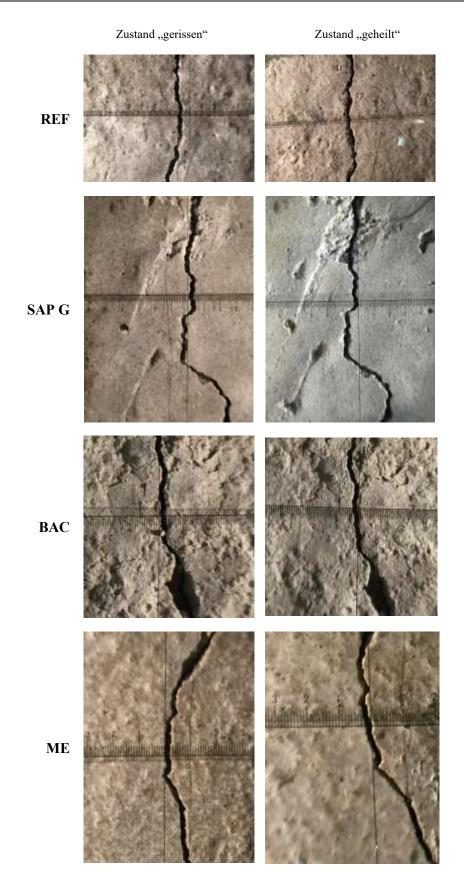
Abbildung 7-10: Optischer Vergleich (Lupenaufnahmen) von oberflächlichen Rissen im definierten Zustand "gerissen" und "geheilt" für Betonplatten mit unterschiedlichen Selbstheilungsmechanismen. Bilder aufgenommen von ACCIONA S.A..
