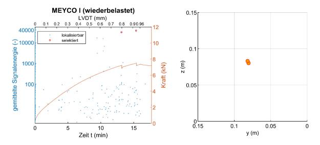
Abbildung 0-9: Zeitabhängiges SE-Auftreten sowie des Kraftkurvenverhaltes während des wiederholten rissweitengesteuerten 3-P-Biegeversuchs von Testkörper "MEYCO I" (links). Die Selektierung der SE-Events (Bancroft-Verfahren) über die gemittelte Signalenergie (rot markiert) führt zu einer erneuten Lokalisierung der eingebetteten Glaskapillaren im mittigen Testkörperbereich (rechts).
