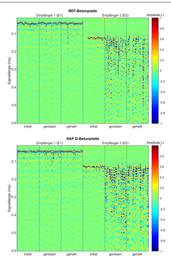
Abbildung 7-12: Zweidimensionaler Amplitudenplot der Ultraschallsignale für "REF"- und "SAP G"-Betonplatte nach Versuchsaufbau aus Abbildung 7-11 (links). Einzelsignale sind auf ihr individuelles Amplitudenmaximum normiert. Fehlerhafte Signale sind mit Leerspalten (Amplitudenwert = 0) ersetzt.
