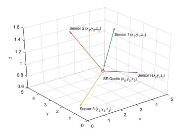
Abbildung 4-6: Theoretisches Modell zur Bestimmung einer Schallemissionsquelle mit 1- i Sensoren.
