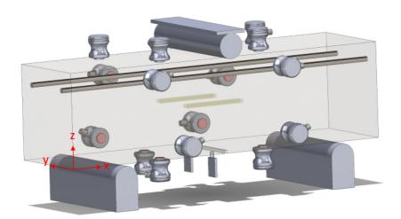
Abbildung 6-12: Schematische Darstellung eines Betontestkörpers mit 15 angekoppelten SE-Sensoren (Panametrics V103-RB), LVDT-Aufnehmern (an Kerbe) und Auflager der 3-Punkt-Biegevorrichtung. In der Mitte befinden sich zwei Glaskapillarenpaare nach der Anordnung aus Abbildung 6-2.
