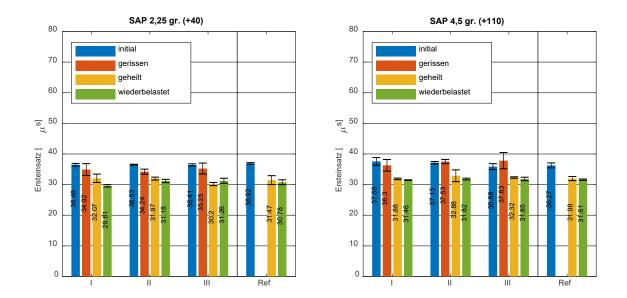
Abbildung 5-19: Gemittelte Ersteinsätze (mit Standardabweichung) für Empfänger E2 über verschiedene Impulsanregungen (Rechteck: 2/4 μs, Sinus: 100/200/300 kHz) zu jedem Zustand während des Versuchablaufs für Mörteltestkörper mit Hydrogelen und zusätzlichem Anmachwasser (links: +40 gr., rechts: +110 gr).
