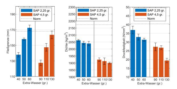
Abbildung 5-14: Fließgrenze (links), Dichte (mitte) und Druckfestigkeit (rechts) für Liapor-Mörtelprismen mit und ohne Bakterien sowie mit unterschiedlichem Extra-Wasser. Die entsprechenden Werte der Normmischung dienen als Referenz.
