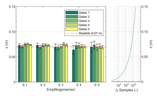
Abbildung 4-2: Quantitative Risstiefenbestimmung mit ToFD-Verfahren nach Gl. 4-5 an einem Betonbalken mit einem 6 mm breiten künstlich eingebrachten Riss. Geometrie und Zusammensetzung des Betonbalkens entsprechen der Prüfserie in Kap. 6.1. Als Geber und Empfängersensoren wurden Panametrics V103 (Firma Olympus) verwendet.
