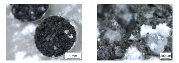
Abbildung 2-4: Nahaufnahme (links) und mikroskopischer Zoom (rechts) geteilter Blähtonkugeln, welche mit einer bakterienbasierten Suspension imprägniert (Vakuumofen) und anschließend getrocknet wurden. Die weißen Geflechte im Inneren sowie an der Außenschale bilden ein Gemisch aus Bakteriensporen, Calciumlaktat und Hefeextrakt.
