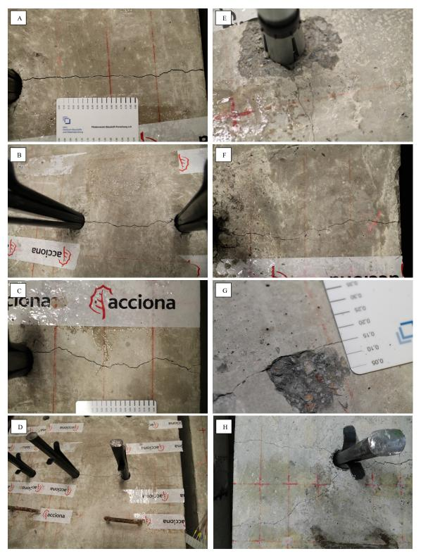
Abbildung 7-9: Rissformationen an verschiedenen Betonplatten, initiiert durch Einschlagkeile und Schwerlastanker. Linke Spalte (A-D): überwiegend gleichmäßige Einzelrisse. Recht Spalte (E-H): Oberflächenbeschädigungen, Mehrfachrisse und Rissvergabelungen sowie ungleichmäßige Rissverläufe.
