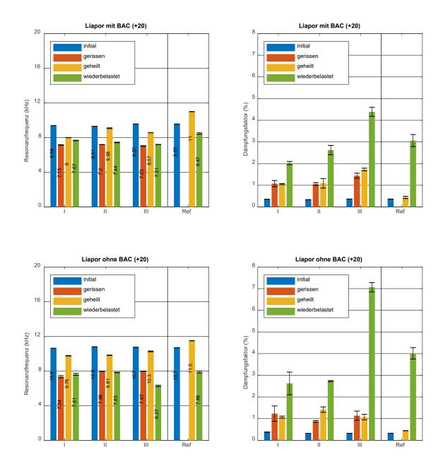
Abbildung 5-29: Resonanzfrequenzen und Dämpfungsfaktor für Mörteltestkörper mit bakterienbasierter Heilung ("Liapor mit BAC") sowie der Referenzprüfserie ("Liapor ohne BAC") für longitudinale Schwingungsanregung.
