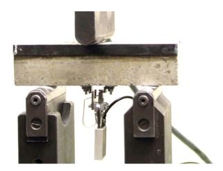
Abbildung 5-1: Versuchsaufbau für rissöffnungsgesteuerten 3-P-Biegeversuch für Mörteltestkörper mit seitlich angebrachter CFK-Lamellen Armierung.
