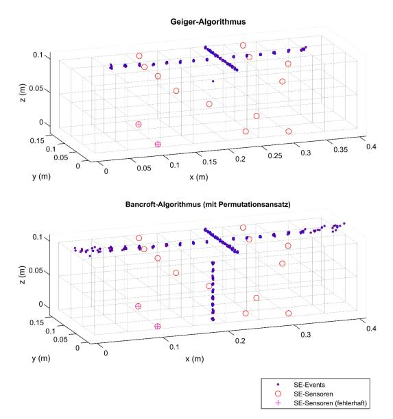
Abbildung 0-1: Dreidimensionale Darstellung der Lokalisierungsergbnisse synthetisch generierter Ankunftszeiten innerhalb der SEAmit dem Geiger- und Bancroft-Verfahren.
