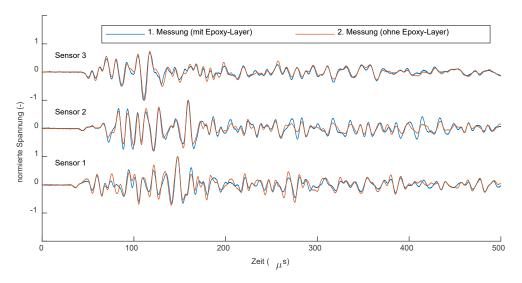
Abbildung 4-12: Ultraschallmessung mit KRNBB-PC-Sensoren an Mörteltestkörper zum Test der Reproduzierbarkeit sowie des Einfluss einer Epoxidharz-Oberflächenbeschichtung. Der durschnittliche Korrelationskoeffizient beträgt  $0.9160 \pm 0.0246$  und liegt etwas unterhalb einer vergleichbaren Messung mit zusätzlicher Epoxidharzbeschichtung als Akoppelfläche.
