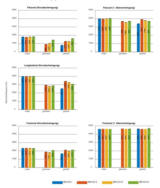
Abbildung 6-11: Flexurale und torsionale Resonanzfrequenzen in der Grund- bzw. 1. Oberschwingung der MEYCO-Betontestkörper zu den unterschiedlichen Zuständen (initial, gerissen, geheilt). Mittelwert und Standardabweichung wurden aus jeweils drei Einzelmessungen gebildet.
