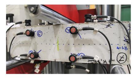
Abbildung 6-3: Initialer 3-P-Biegeversuch eines Betontestkörpers mit angebrachten Schallemissionssensoren (Olympus Panamterics V103-RB). Die rissweitengesteuerte Belastung wird mittels LVDT-Wegmessung kontrolliert.
