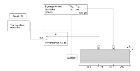
Abbildung 6-7: Experimenteller Versuchsaufbau für ToFD-Messungen an MEYCO-Betontestkörpern.
