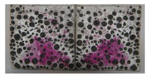
Abbildung 5-13: Optischer Vergleich des carbonatisierten Rissquerschnittes von jeweils zwei Mörtelprismen der Prüfserie "Liapor mit BAC" (oben) sowie der Referenzprüfserie "Liapor ohne BAC" (unten) nach Abschluss des 6-wöchigen Nass-Trockenzyklus. Zur Identifikation der Carbonatisierungseindringtiefe wurden die Rissflächen mit Phenolphthalein eingesprüht. Die Rissöffnung befindet sich, identisch zur Lagerungsposition während der Heilungsphase, oberseitig.
