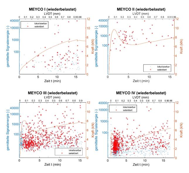
Abbildung 6-14: Zeitabhängiges SE-Auftreten sowie des Kraftkurvenverhaltes während der Wiederbelastung durch einen rissweitengesteuerten 3-P-Biegeversuch für Betontestkörper "MEYCO I-IV". Die Selektierung (Bancroft-Verfahren) wurde bestimmt durch den Korrelationskoeffizient (0,5) und der Mindestanzahl an Permutations-Ergebnissen (> 40).
