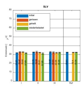
Abbildung 5-17: Gemittelte Ersteinsätze (mit Standardabweichung) für Empfänger E2 über verschiedene Impulsanregungen (Rechteck:  $2/4~\mu s$ , Sinus: 100/200/300~kHz) zu jedem Zustand während des Versuchablaufs für Mörteltestkörper mit manuell induziertem Polyurethan HA Flex SLV AF.
