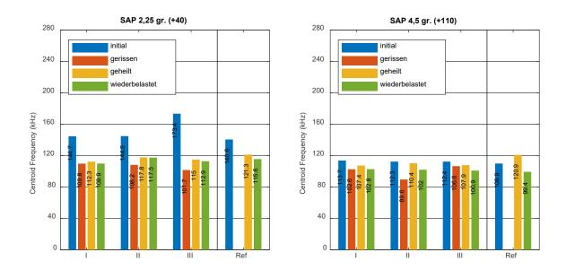
Abbildung 5-24: Centroid Frequency für Mörteltestkörper mit 2,5 gr. Hydrogelgranulat (links) plus 40 gr. Extrawasser und 4,5 gr. Hydrogelgranulat (links) mit 110 gr. Extrawasser bei 2μs-Einzelimpulsanregung, berechnet für Empfänger E2.
