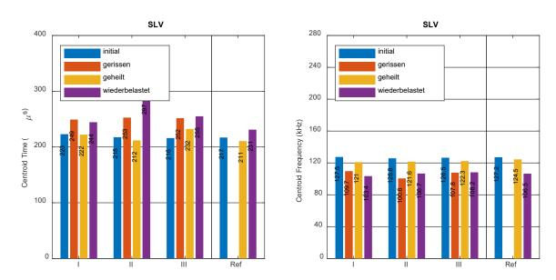
Abbildung 5-20: Centroid Time (links) und Centroid Frequency (rechts) für Mörteltestkörper mit manueller Heilung ("SLV") bei 2µs-Einzelimpulsanregung, berechnet für Empfänger E2.
