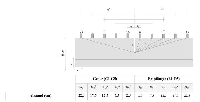
Abbildung 4-1: Geber- Empfängersensoranordnung zur Überprüfung der quantitativen Genauigkeit der Risstiefendetektion mit dem ToFD-Verfahren.
