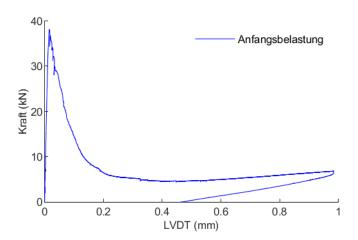
Abbildung 6-4: Exemplarisches Kraft-Rissöffnungsverhalten wärend des initialen 3-Punkt-Biegeversuchs von Testkörper "MEYCO IV". Das rissweitengesteuerte Belastungsszenario erfolgte bis 1 mm, was zu einem plastischen Verformungsverhalten führt. Die Wiederbelastung nach der Selbstheilung/Aushärtung erfolgte ebenfalls bis 1 mm, sodass die maximale Rissweite aus der initialen Belastung um diesen Wert überschritten wird.
