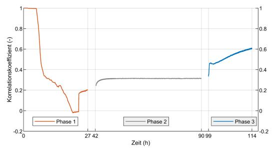
Abbildung 6-24: Vollständige In-situ-Überwachung eines Betontestkörpers mit anschließender manueller Verfüllung des Risses mit "SLV". Phase 1: Initialer 3-P-Biegeversuch mit anschließender Entlastung. Phase 2: Relaxation. Phase 3: Manuelle Verfüllung mit "SLV" und Aushärtung.
