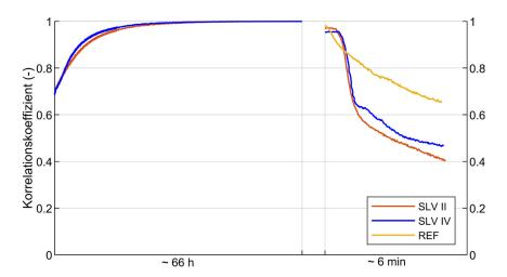
Abbildung 6-23: In-situ-Beobachtung der Aushärtung sowie der anschließenden Wiederbelastung mit Ultraschall. Im Vergleich ein gerissener Referenztestkörper ohne Verfüllung während der Wiederbelastung.
