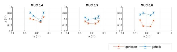
Abbildung 7-6: Risstiefenbestimmung mit ToFD-Verfahren für "REF"- und "MUC"-Betonbalken mit Rissweiten von 0,4-0,6 mm. Zur besseren Übersicht sind die jeweils vier Messpunkte je Querschnitt miteinander verbunden dargestellt.
