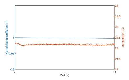
Abbildung 4-5: Ultraschall In-situ-Kalibriermessung in Transmission mit Olympus Panametrics V150-RB Sensoren an Betontestkörper aus Kapitel 6.2 (400 x 150 x 100 mm) über 18 h in Klimakammer (20 °C, 65 % rel. Feuchte).
