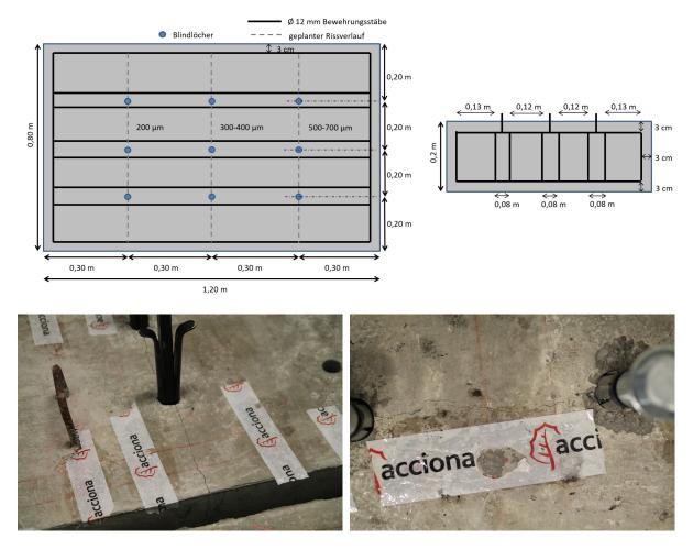
Abbildung 7-8: Bewehrungs- und Rissinitiierungskonzept für Betonplatten. Die spezielle Bewehrungsanordnung ermöglichte mittels Einschlagkeile und Schwerlastanker eine gezielte Rissöffnung mit anschließender Stabilisierung.
