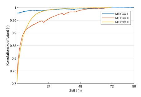
Abbildung 6-10: Ultraschall In-situ-Messung während der Heilungsphase von MEYCO-Betontestkörpern mit eingebetteten Glaskapillaren.
