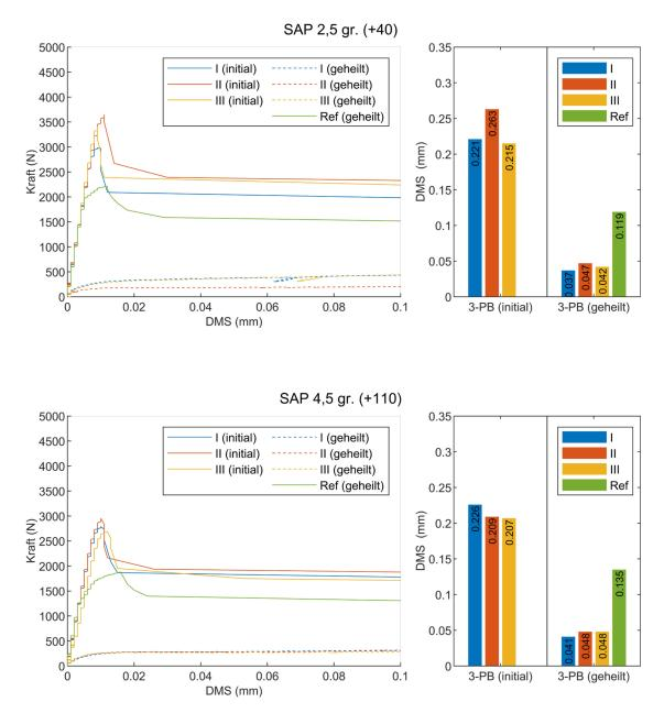
Abbildung 5-15: Detaillierter Kraft-Dehnungs- (Rissöffnungs-) verlauf für Mörteltestkörper mit 2,25 gr. Hydrogelgranulat und 40 gr. zusätzlichem Wasser (oben) sowie Mörtelprismen mit 4,5 gr. Hydrogelgranulat und 110 gr. zusätzlichem Wasser (unten) des initialen 3-Punkt-Biegeversuch (=Anfangsbelastung) und nach 6-wöchigem Nass-Tockenzyklus mit anschließender Trocknung (=Wiederbelastung). Das Balkendiagramm gibt die finalen Rissweiten in den jeweiligen Zuständen wieder.
