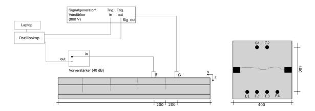
Abbildung 7-5: Links: Mobiler Versuchsaufbau für Ultraschalltransmissionsmessungen an Betonbalken. Rechts: Schematische Darstellung der Sensorplatzierung.
