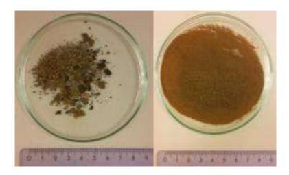
Abbildung 2-6: Zyklisch angereichertes ureolytisches Pulver zur Verwendung von autonomen Selbstheilungseffekten durch CaCO<sub>3</sub>-Bildung. Links: Rohprodukt nach zyklisch thermischer Herstellung. Rechts: Finales Produkt nach Feinmahlung für die Zugabe in zementgebunden Werkstoffen.
