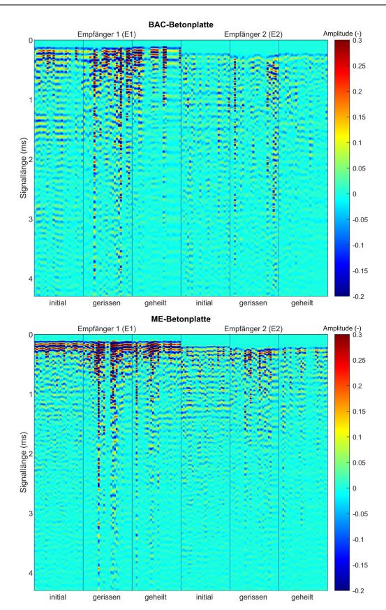
Abbildung 7-15: Zweidimensionaler Amplitudenplot der detektierten akustischen Schallwellen nach Impaktanregung für "BAC"- und "ME"-Betonplatte. Versuchsaufbau entsprechend Abbildung 7-11 (links). Einzelsignale sind auf das Amplitudenmaxium des jeweilgen Impaktes normiert. Fehlerhafte Signale sind mit Leerspalten (Amplitudenwert = 0) ersetzt.
