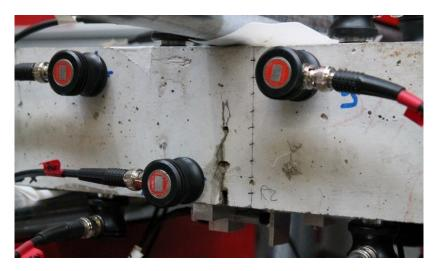
Abbildung 6-18: Initiale Bruchinitiierung via 3-Punkt-Biegeversuch. Wenige Sekunden nach Bruch der Glaskapillaren dringt das PU "SLV" entlang des Risses an die Testkörperoberffläche. Angebrachte Sensoren dienen der Schallemissionsanalyse.
