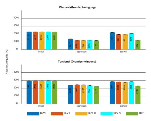
Abbildung 6-26: Flexurale und torsionale Resonanzfrequenzen in der Grundschwingung der "SLV"-Betontestkörper zu den unterschiedlichen Zuständen (initial, gerissen, geheilt). Mittelwert und Standardabweichung wurden aus jeweils drei Einzelmessungen gebildet.
