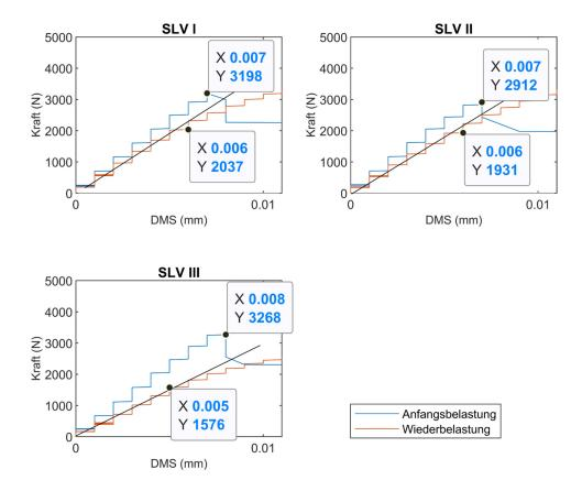
Abbildung 0-4: Detaillierter Kraft-Dehnungs- (Rissöffnungs-) verlauf für Mörteltestkörper "SLV I-III" im Bereich von 0,0 bis 0,011 mm nach manueller Verfüllung mit dem PU "SLV". Die schwarze Gerade innerhalb der Wiederbealstungskurve gibt das lineare Kraft-Dehnungsverhältnis des Polymers wieder. Die Dehnung der zementgebunden Mörtelmatrix wird während der initialen Belastug als linear angenommen. Die entsprechenden Maximalwerte (X: max. Dehnung, Y: max. Kraft) sind über die "Data-Tips" gegeben.
