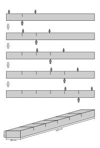
Abbildung 7-1: Links: Schalungskonzept mit integrierter Bewehrung für Betonbalken mit 250x40x20 cm. Mitte: Realbild der Schalungsform mit Bewehrung (Hinweis: Stellt einen Entwurf mit Bewehrungsstäbe anstatt Glasfaserstäbe dar). Rechts: Konzept der mehrfachen Rissinitiierung über manuelle 3-P-Biegeversuche. Bilder wurden erstellt von DTI Kopenhagen (Dänemark).
