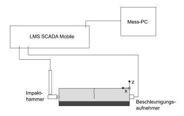
Abbildung 5-26: Messaufbau für Schwingungsanalyse an Mörteltestkörpern. Skizze zeigt Messaufbau für longitudinale Anregung.
