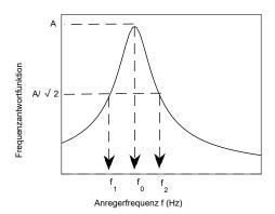
Abbildung 4-9: Transferfunktion für die Dämpfungsbestimmung.
