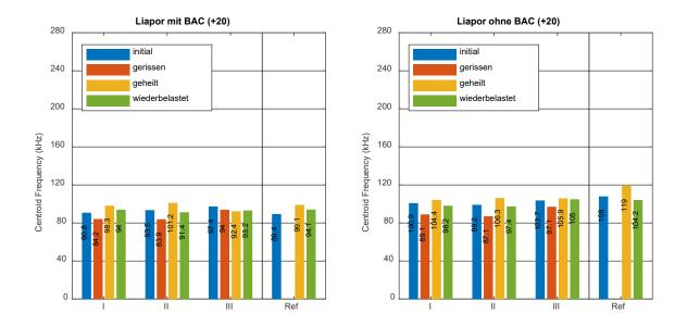
Abbildung 5-22: Centroid Frequency für Mörteltestkörper mit imprägnierten (links) und nicht-imprägnierten (rechts) Liapor-Tonkugeln für eine bakterienbasierte Selbstheilung bei 2µs-Einzelimpulsanregung, berechnet für Empfänger E2.
