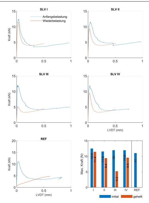
Abbildung 6-20: Kraft-Rissöffnungsverhalten für SLV-Betontestkörper während des initialen 3-Punkt-Biegeversuchs (=Anfangsbelastung) und drei Tage nach der Selbstheilung /Aushärtung (=Wiederbelastung) sowie eine Übersicht über die maximalen Wiederbelastungswerte infolge der Rissverschließung.
