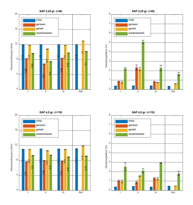
Abbildung 5-31: Resonanzfrequenzen und Dämpfungsfaktor für Mörteltestkörper mit einer autogen verstärkten hydrogelbasierten Heilung ("SAP 2,25 gr."/"SAP 4,5 gr.") für longitudinale Schwingungsanregung.
