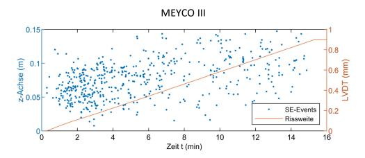
Abbildung 0-10: Zeitabhängiges SE-Auftreten mit entsprechenden Lokalisierungsergbnisse in z-Achse für "MEYCO III".
