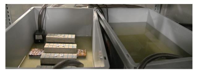
Abbildung 5-10: Versuchsaufbau für Nass-Trockenzyklus für Mörteltestkörper mit Liapor-Ton-Kugeln sowie Hydrogelgranulat.
