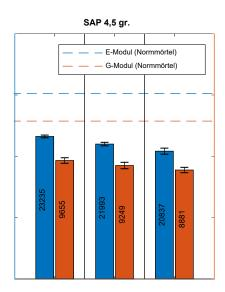
Abbildung 5-30: Dynamischer Elastizitätz- und Schermodul für Mörteltestkörper mit einer autogen verstärkten hydrogelbasierten Heilung ("SAP 2,25 gr."/"SAP 4,5 gr.") aus longitudinaler Schwingungsanregung.
