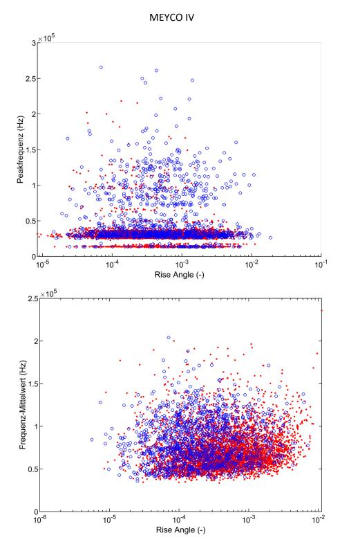
Abbildung 0-12: Selektierung der einzelnen Sensorsignale je SE-Event (kein Clipping) nach unterschiedlichen frequenzbasierten Charakteristika (oben: Peakfrequenz, unten: Frequenz-Mittelwert) des zweiten Biegeversuchs (nach Abschluss Heilungsphase). Rote Punkte zeigen Events mit t<4 min und z<0,05 m, blaue Kreise repräsenieren Events mit t>4 min und z>0,05 m.
