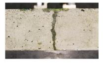
Abbildung 5-4: Links: Manuelle Verfüllung des Risses mit niedrigviskosem Polyurethan (angereichert mit fluorizierenden Pigmenten). Mitte: Ausgehärtetes Heilmittel nach 4 Tagen (Bild zeigt "SLV II"). Rechts: Bildung neuartiger Rissstrukturen nach Heilung und anschließender Wiederbelastung (Bild zeigt "SLV II").
