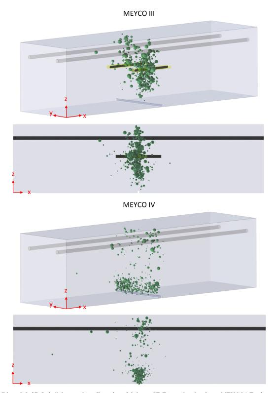
Abbildung 0-8: 3D-Lokalisierungsdarstellung der selektierten SE-Events der einzelnen "MEYCO"-Testkörper aus Kapitel 6.1.5.. Darstellung mit Bewehrungsstäben und individueller Glaskapillarenanordnung. Die Größe der Kugeln steht in einem logarithmischen Bezug zur gemittelten Energie über alle relevanten Sensoren je SE-Event.
