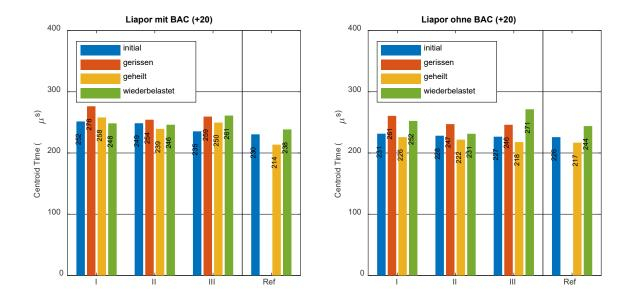
Abbildung 5-21: Centroid Time für Mörteltestkörper mit imprägnierten (links) und nicht-imprägnierten (rechts) Liapor-(Ton)Kugeln für eine bakterienbasierte Selbstheilung bei 2µs-Einzelimpulsanregung für Empfänger E2.
