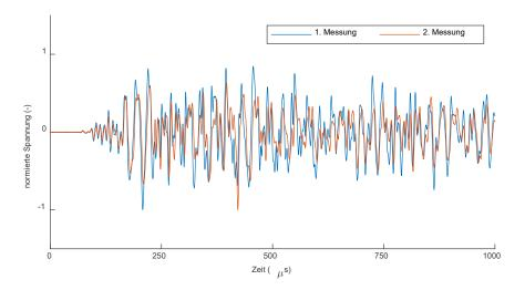
Abbildung 4-14: Indirekte Ultraschalltransmissionsmessung mit Olympus Panametrics V103-Sensoren an gerissenem Betonbalken aus Großversuch zum Test der Reproduzierbarkeit (Sensordistanz: 40 cm, Anregerfrequenz:  $350\,\mathrm{kHz}$ , Abtastrate:  $20\,\mathrm{MHz}$ , Betrachtete Signallänge:  $1000\,\mu\text{s}$ ). Der Korrelationskoeffizient beträgt 0.7.
