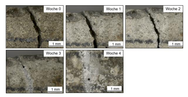
Abbildung 2-3: Beispielhafte Darstellung einer zeitabhängigen bakterienbasierten Rissverschließung aufgrund von Calciumcarbonatablagerungen [Wang et al. 2014].
