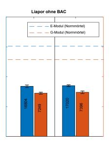
Abbildung 5-28: Dynamischer Elastizitäts- und Schermodul für Mörteltestkörper mit bakterienbasierter Heilung ("Liapor mit BAC") sowie der Referenzprüfserie ("Liapor ohne BAC") aus longitudinaler Schwingungsanregung.
