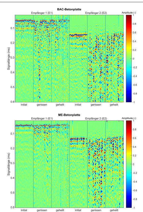
Abbildung 7-13: Zweidimensionaler Amplitudenplot der Ultraschallsignale für "BAC"- und "ME"-Betonplatte nach Versuchsaufbau aus Abbildung 7-11 (links). Einzelsignale sind auf ihr individuelles Amplitudenmaximum normiert. Fehlerhafte Signale sind mit Leerspalten (Amplitudenwert = 0) ersetzt.
