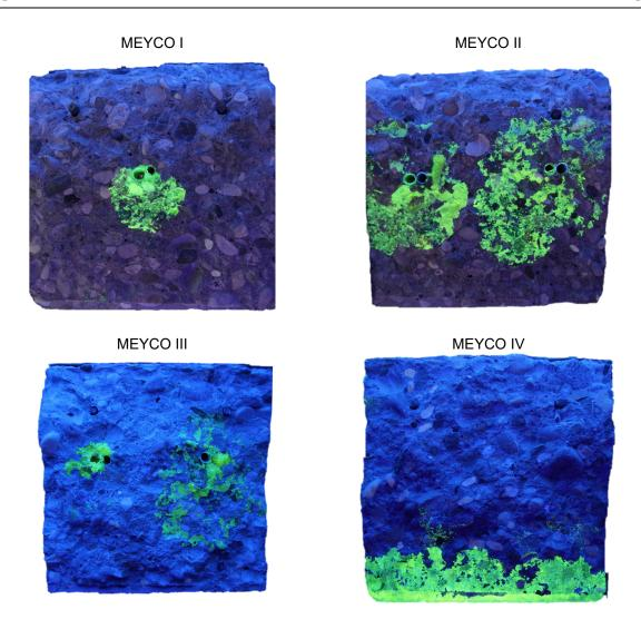
Abbildung 6-6: Querschnittsflächen der Risszone der Betontestbalken mit freigesetztem Heilmittel "MEYCO". Um die Sichtbarkeit der Polyurethan-basierten Heilmittelverteilung zu verbessern, wurden fluorezierende Pigmente hinzugefügt.
