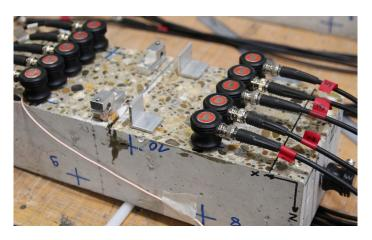
Abbildung 6-21: Sensorplatzierung an SLV-Testkörpern für ToFD-Messung.
