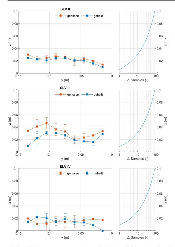
Abbildung 0-13: Risstiefenbestimmung von Testkörper "SLV II-IV" (tomografischer Ansatz) nach Rissinitiierung und nach dreitägiger Heilung.
