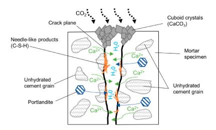
Abbildung 2-1: Schematische Darstellung der Funktionsweise einer autogenen Selbstheilung zwischen zwei Rissflanken [Rajczakowska et al. 2019].
