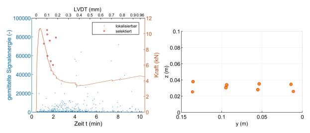
Abbildung 6-28: Links: Zeitabhängige SE-Aktivität sowie das Kraftkurvenverhalten während des initialen rissweitengesteuerten 3-P-Biegeversuchs von Referenztestkörper "REF". Eine Selektierung der Events bis t=3 min mit anschließender Lokalisierung (rechts) deutet bereits auf eine vollständige Aktivierung aller eingebrachten Glaskapillaren.
