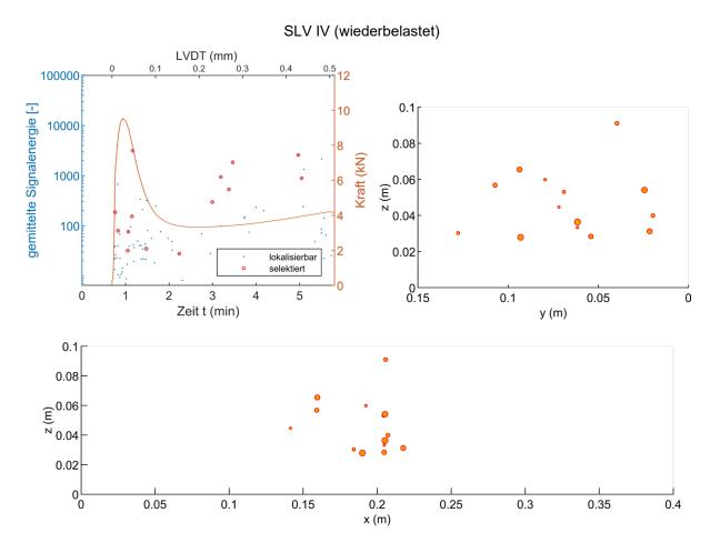
Abbildung 6-29: Ergebnisse der SEA während der Wiederbelastung innerhalb der "SLV"-Betontestkörperserie. Jeweils links oben: Zeitabhängige SE-Aktivität sowie das Kraftkurvenverhalten des rissweitengesteuerten 3-P-Biegeversuchs. Jeweils rechts oben und unten: Lokalisierung der selektierten SE-Events über die gemittelte Signalenergie (rot markiert) führt zu einer Lokalisierung (Bancroft-Verfahren) der eingebetteten Glaskapillaren im mittigen Testkörperbereich.
