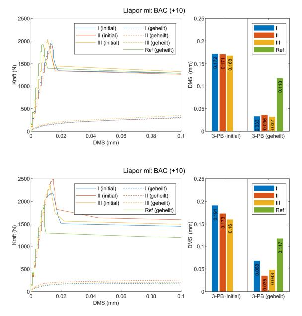
Abbildung 0-5: Detaillierter Kraft-Dehnungs- (Rissöffnungs-) verlauf für bakterienbasierte Mörteltestkörper (oben) sowie Referenzprüfserie (unten) mit 10 gr. zusätzlichem Wasser des initialen 3-Punkt-Biegeversuch (=Anfangsbelastung) und nach 6-wöchigem Nass-Tockenzyklus mit anschließender Trocknung (=Wiederbelastung). Das Balkendiagramm gibt die finalen Rissweiten in den jeweiligen Zuständen wider.
