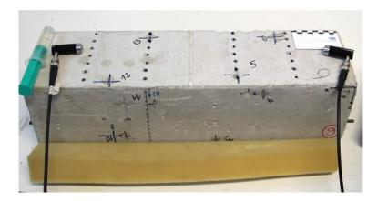
Abbildung 6-8: Versuchsaufbau für TofD-Messung an MEYCO-Testkörpern mit manueller Sensorankopplung (UP-DW, Geotron Elektronik).
