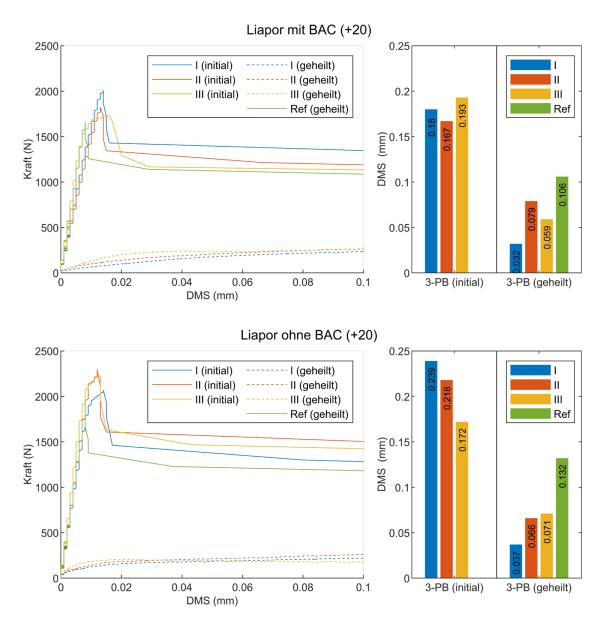
Abbildung 5-11: Detaillierter Kraft-Dehnungs- (Rissöffnungs-) Verlauf für bakterienbasierte Mörteltestkörper (oben) sowie Referenzprüfserie (unten) mit 20 gr. zusätzlichem Wasser des initialen 3-Punkt-Biegeversuch (= Anfangsbelastung) und nach 6-wöchigem Nass-Tockenzyklus mit anschließender Trocknung (= Wiederbelastung). Das Balkendiagramm gibt die finalen Rissweiten in den jeweiligen Zuständen wieder.
