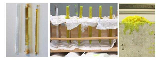
Abbildung 2-7: Links, Mitte: Glaskapillaren gefüllt mit polyurethanbasiertem Heilmittel. Rechts: Schaumartige Struktur nach manueller Rissinjektion von PU-Injektionsschaum und Beschleuniger.
