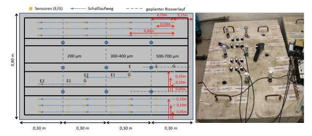
Abbildung 7-11: Links: Schematischer Versuchsausbau für Ultraschall- und Impaktmessungen an Betonplatten. Rechts: Realbild einer US-Messung an REF-Testkörper.
