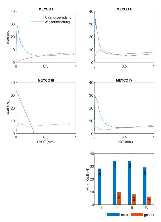
Abbildung 6-5: Kraft-Rissöffnungsverhalten für MEYCO-Testkörper während des initialen 3-Punkt-Biegeversuchs (=Anfangsbelastung) und sieben Tage nach der Selbstheilung /Aushärtung (=Wiederbelastung). Die einzelnen Spitzenlasten sind zudem im Balkendiagram dargestellt. Aufgrund fehlerhafter Einstellungen der Anfangsbelastung für "MEYCO III" ist der Versuch nach Erreichen der Spitzenlast abgebrochen worden.
