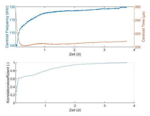
Abbildung 5-25: In-situ-Monitoring des Verfüll- und Aushärteverhaltens mit Ultraschall (2  $\mu$ s-Einzelimpulsanregung für Empfänger E2) von "SLV" in Mörteltestkörper ("SLV II") über einen Versuchszeitraum von circa 90 h. Oben: Centroid Frequency und Centroid Time. Unten: Korrelationskoeffizient.
