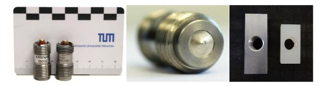
Abbildung 4-10: Ultraschall KRNBB-PC Sensor mit individuell gefertiger Halterung aus Aluminium und PVC.
