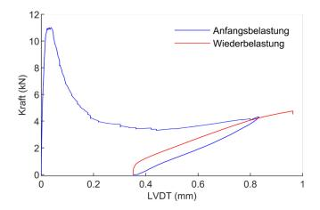
Abbildung 6-17: Exemplarisches Kraft-Rissöffnungsverhalten eines Referenztestkörpers ohne PU-Kapillaren. Rissöffnungsgesteuertes Belastungsszenario mit LVDT-Aufnahmern bis maximal 1,0 mm. Wiederbelastung erfolgt nach vollständiger Kraftentlastung bis maximal 0,5 mm.
