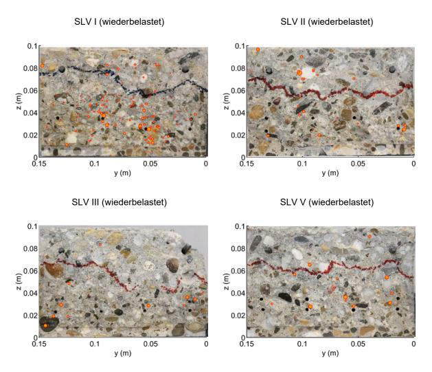
Abbildung 6-30: Lokalisierungsdarstellung der selektierten SE-Events der einzelnen "SLV"-Testkörper aus der vorherigen Abbildung 6-19 mit dem Bancroft-Verfahren in der y-z-Ebene. Die Größe der Kreise steht in einem logarithmischen Bezug zur gemittelten Energie über alle relevanten Sensoren je SE-Event. Im Gegensatz zur "MEYCO"-Testserie lässt die im Hintergrund befindliche Querschnitts-Rissfläche keinen Vergleich mit der autonomen Verfüllung des PUs durch die Glaskapillaren zu.
