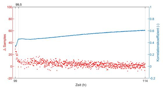
Abbildung 6-25: Detailierte Darstellung von "Phase 3" aus Abbildung 6-24. Parallel zum Korrelationskoeffizient sind die Sample-Differenzen vom Ersteinsatz des ungeschädigten Betonbalkens (t=0 in "Phase 1") aufgeführt. Die Ersteinsatzbestimmung erfolgte automatisiert mittels AIC-Picker. Fehlerhafte Ersteinsätze wurden manuell herausgeführt.
