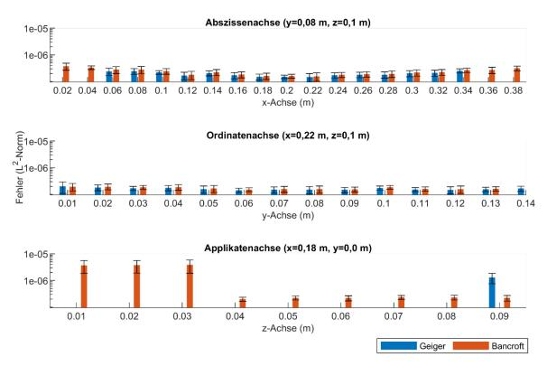
Abbildung 0-3: Bestimmung des Gesamtfehlers nach L<sup>2</sup>-Norm (RES) zu definierten Quellherden aus der Berechnung mit synthetischen Ankunftszeiten innerhalb der SEA mit dem Geiger- und Bancroft-Verfahren.
