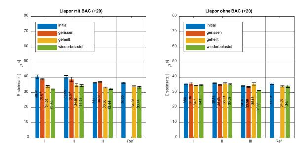
Abbildung 5-18: Gemittelte Ersteinsätze (mit Standardabweichung) für Empfänger E2 über verschiedene Impulsanregungen (Rechteck:  $2/4~\mu s$ , Sinus: 100/200/300~kHz) zu jedem Zustand während des Versuchablaufs für Mörteltestkörper mit imprägnierten Liapor(Ton)-Kugeln (links) und ohne (rechts) .
