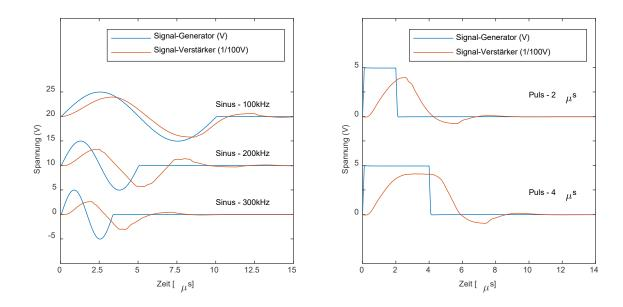
Abbildung 0-7: Anregerimpulse für Mörteltestkörper. Die analoge Verstärkung des konfigurierten Impulssignals (blau) über den Messverstärker Trek Model PZD350A führte zu einer Signalformveränderung (rot).
