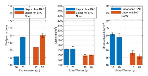
Abbildung 5-9: Fließgrenze (links), Dichte (mitte) und Druckfestigkeit (rechts) für Liapor-Mörtelprismen mit und ohne Bakterien sowie mit unterschiedlichem Extra-Wasser. Die entsprechenden Werte der Normmischung dienen als Referenz.
