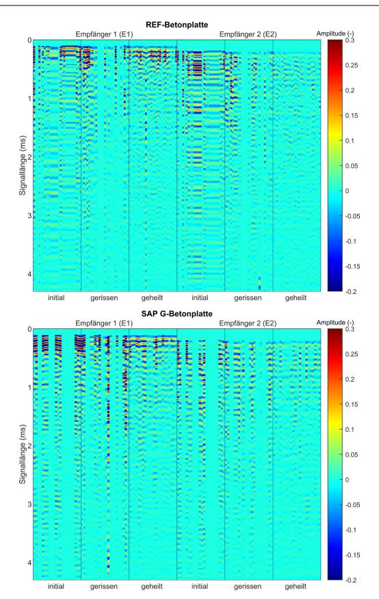
Abbildung 7-14: Zweidimensionaler Amplitudenplot der detektierten akustischen Schallwellen nach Impaktanregung für "REF"- und "SAP G"-Betonplatte. Versuchsaufbau entsprechend Abbildung 7-11 (links). Einzelsignale sind auf das Amplitudenmaxium des jeweilgen Impaktes normiert. Fehlerhafte Signale sind mit Leerspalten (Amplitudenwert = 0) ersetzt.
