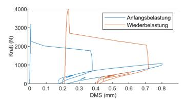
Abbildung 5-3: Kraft-Dehnungs- (Rissöffnungs-) verlauf für Mörteltestkörper "SLV I". Rissöffnungsgesteuertes Belastungsszenario bis maximal 0,8 mm mit DMS-Aufnahmern. Wiederbelastung erfolgt nach vollständiger Kraftentlastung bis maximal 0,4 mm.
