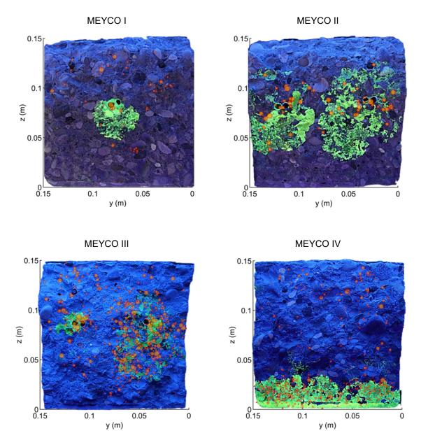
Abbildung 6-15: Lokalisierungsdarstellung der selektierten SE-Events der einzelnen "MEYCO"-Testkörper aus der vorherigen Abbildung 6-14 mit dem Bancroft-Verfahren in der y-z-Ebene. Die Größe der Kreise steht in einem logarithmischen Bezug zur gemittelten Energie über alle relevanten Sensoren je SE-Event. Die im Hintergrund befindliche Querschnitts-Rissfläche lässt einen Vergleich mit der autonomen Verfüllung des PUs durch die Glaskapillaren zu.
