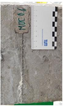
Abbildung 7-3: Links: Multible Rissbildung an Groß-Balken nach Rissinitiierung (Aufsicht: "REF 0,4"). Rechts: Rissbetrachtung nach Heilungsphase (Seitenansicht: "MUC 0,6").
