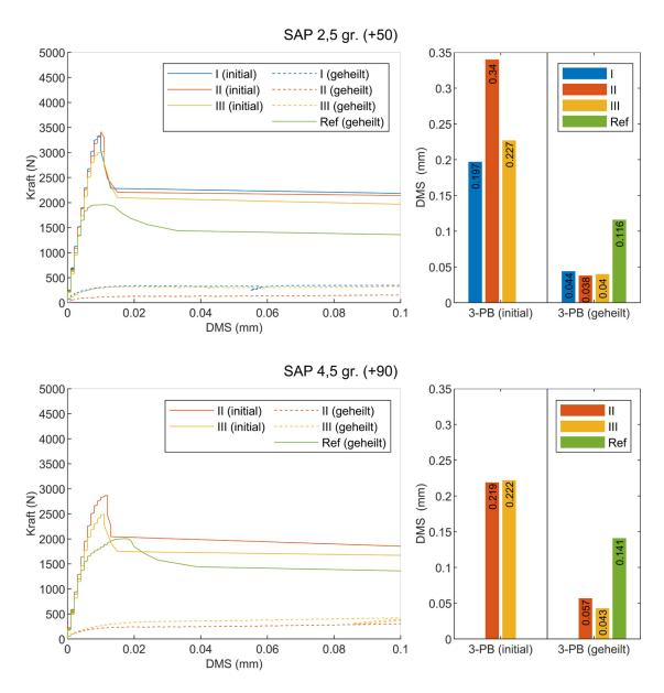
Abbildung 0-6: Detaillierter Kraft-Dehnungs- (Rissöffnungs-) verlauf für Mörteltestkörper mit 2,25 gr. Hydrogelgranulat und 50 gr. zusätzlichem Wasser (oben) sowie Mörtelprismen mit 4,5 gr. Hydrogelgranulat und 90 gr. zusätzlichem Wasser (unten) des initialen 3-Punkt-Biegeversuch (=Anfangsbelastung) und nach 6-wöchigem Nass-Tockenzyklus mit anschließender Trocknung (=Wiederbelastung). Das Balkendiagramm gibt die finalen Rissweiten in den jeweiligen Zuständen wider.
