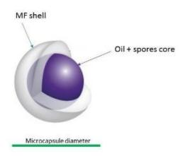
Abbildung 2-5: Schematisches Kernschalenmodell einer Mikrokapsel mit Melamin-Formaldehyd-Schale (MF) und Öl als Träger [Consortium 2017].
