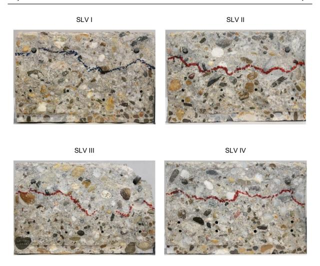
Abbildung 6-19: Querschnittsbilder der SLV-Betontestprüfkörper. Die eingezeichnete Linie markiert die maximale Dispersionshöhe des freigesetzten PUs "SLV" nach der Bruchinitiierung.
