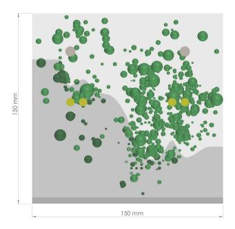
Abbildung 8-1: Kombinierte Betrachtung der Ergebnisse aus ToFD-Verfahren und Schallemissionsanalyse nach bzw. während wiederkehrender Belastung. 3D-CAD Darstellung<sup>33</sup> zeigt Querschnitt von "MEYCO III" mit obenliegender Bewehrung (grau), zwei Paar Glaskapillaren (gelb), SE-Events (grün, Größe der Events ist energieabhängig) sowie die Grenztiefe aus der Risstiefenbestimmung. Die Grenzfläche der unterschiedlich grauen Flächen stellt dabei den detektierten Verbund mit PU dar.
