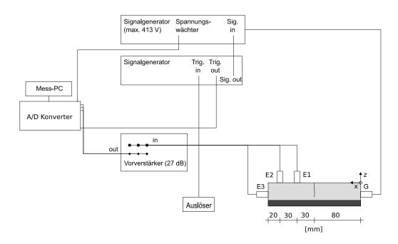
Abbildung 5-16: Experimenteller Messaufbau für Ultraschalltransmissionsmessungen an Mörteltestkörpern mit Selbstheilungseigenschaften.
