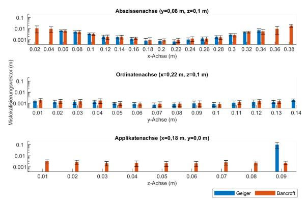
Abbildung 0-2: Mislokalisationsvektoren zu definierten Quellherden aus der Berechnung mit synthetischen Ankunftszeiten innerhalb der SEA mit dem Geiger- und Bancroft-Verfahren.
