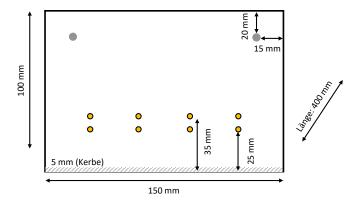
Abbildung 6-16: Schematischer Aufbau der bewehrten (grau) Betonbalkenserie "SLV" mit Polyurethan-gefüllten Glaskapillaren (hier: 8 Glasskapillare - gelb markiert).
