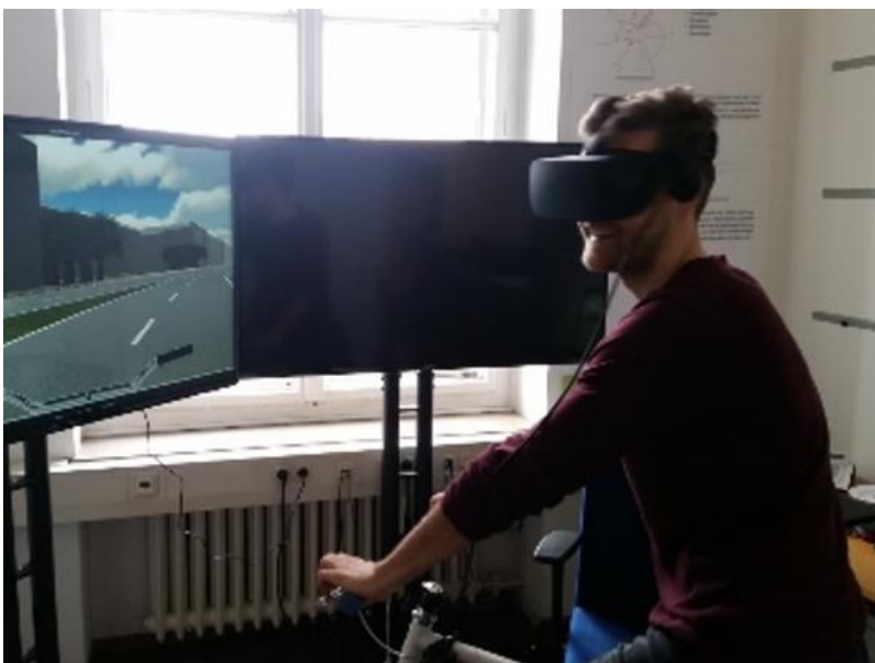
Bild 4: Mögliche Konstellationen des Fahrradsimulators mit Nutzung der VR-Brille (links) oder drei Monitoren (rechts)
