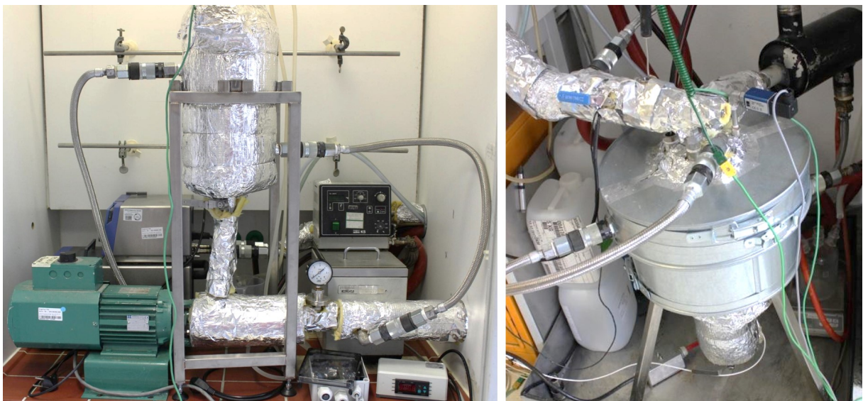
Abbildung A.1: Versuchsapparatur zur Untersuchung der kontinuierlichen Entspannungsverdampfung im erweiterten Labormaßstab. Vorlagebehälter B-21 mit Pumpe P-21 und Thermostaten TO-21 und TO-22 (links) und Entspannungsbehälter B-22/B24 mit Kondensator WT-23 und Destillatabscheider B-23 (rechts).
