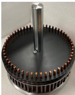
**Abbildung 5.10:** Versuchsträger zur Verschweißung von Hairpin-Paaren.
