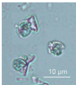
Abb. 54 Streupräparat KB-79 in Mm, gerundete blau-grüne Pigmentpartikel des künstlichen Kupferpigments.
