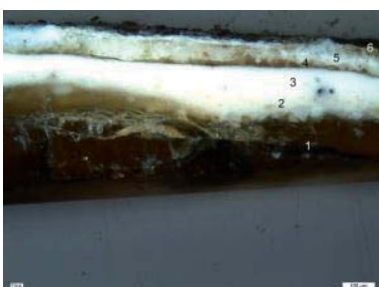
Abb. 42 Querschliff KB-73, VIS/DF, weiße Fassung der Akanthusranke, Feld 9 ( Abb. 39 ). Vielschichtiger, bindemittelreicher Fassungsaufbau ( Anhang S. XXV ).
