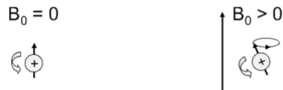
Abb. 4 Präzession des Kernspins um die z-Achse in einem Magnetfeld mit der Feldstärke B_0
