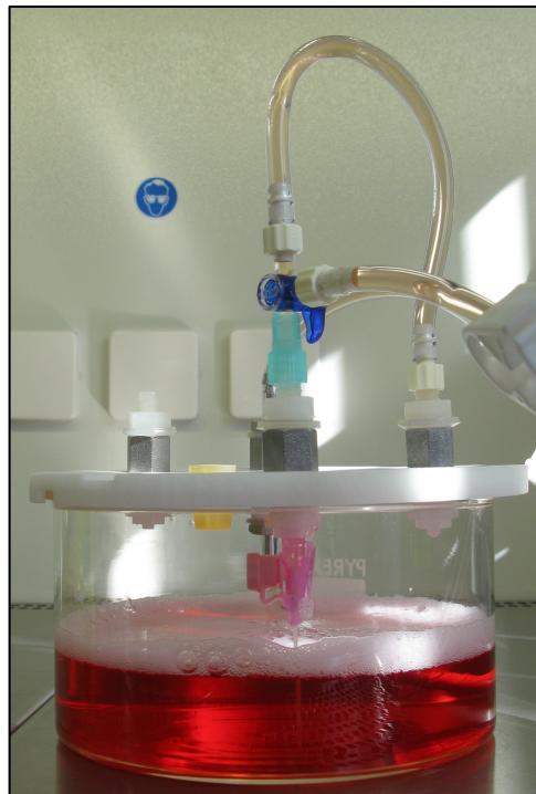
Abbildung 15: Schaumbildung im Miniaturinkubator während des ersten Durchspülprozesses unter sterilen Bedingungen in der sterilen Werkbank
