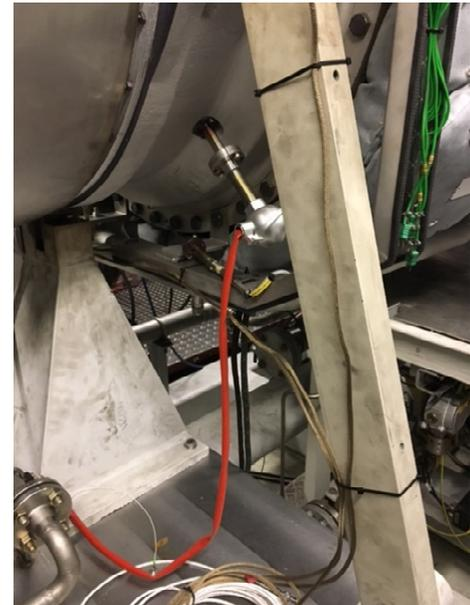
**Abbildung 6-3:** (a) Azimutale Anordnung (Winkelgrad) der Messsonden im Abgasstrang der Gasturbine (Strömungsrichtung senkrecht zur Zeichnungsebene). (b) Foto der eingebauten faseroptischen Temperatursonde.
