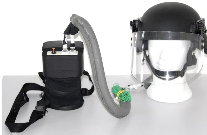
Abbildung 20. Aktives Kühlsystem einschließlich aller Komponenten. Links: Kühleinheit, rechts: Helm mit Helminlay. (Eigene Darstellung)
