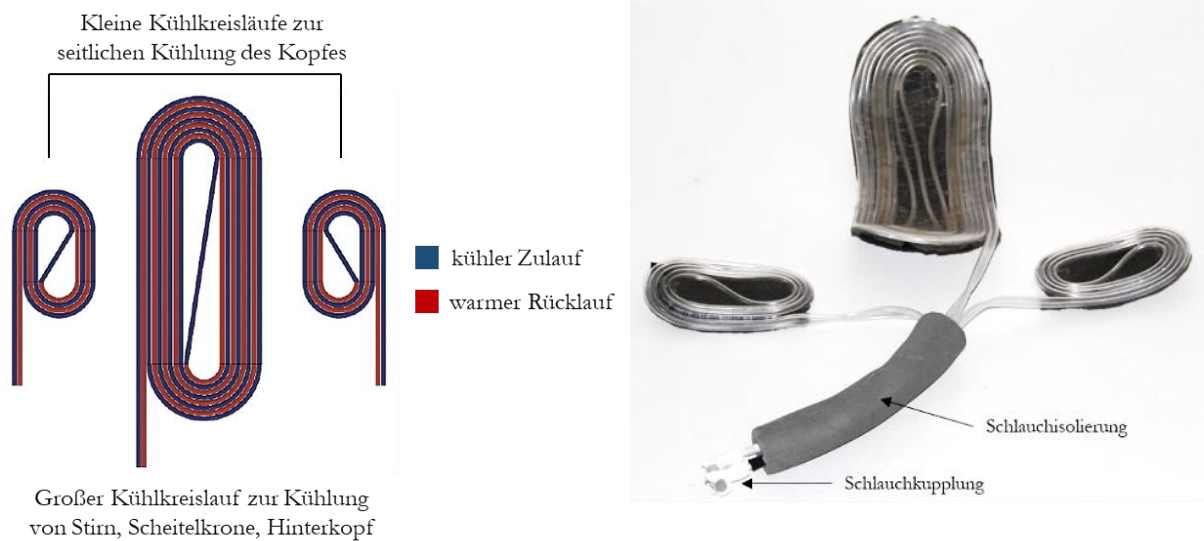
Abbildung 24. Helminlay; Links: CAD-Modell der drei Kühlkreisläufe (Stöckl, 2018, S. 63); Rechts: Prototyp des Helminlays (eigene Darstellung).
