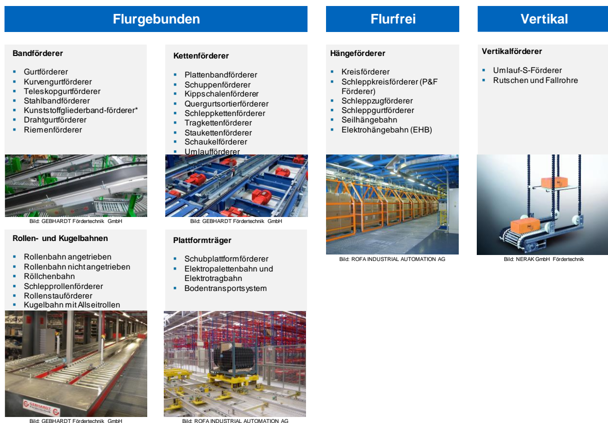
Abbildung 2-2: Übersicht an verschiedenen stetigen Fördermitteltypen nach [Fot-2019, S. 47] und [VDI-4440] (Bilder: GEBHARDT Fördertechnik GmbH, ROFA INDUSTRIAL AUTOMATION AG und NERAK GmbH Fördertechnik).
