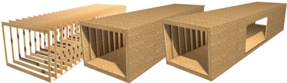
Figure 3 : Système construction Dhomino (source : Dhomino)
