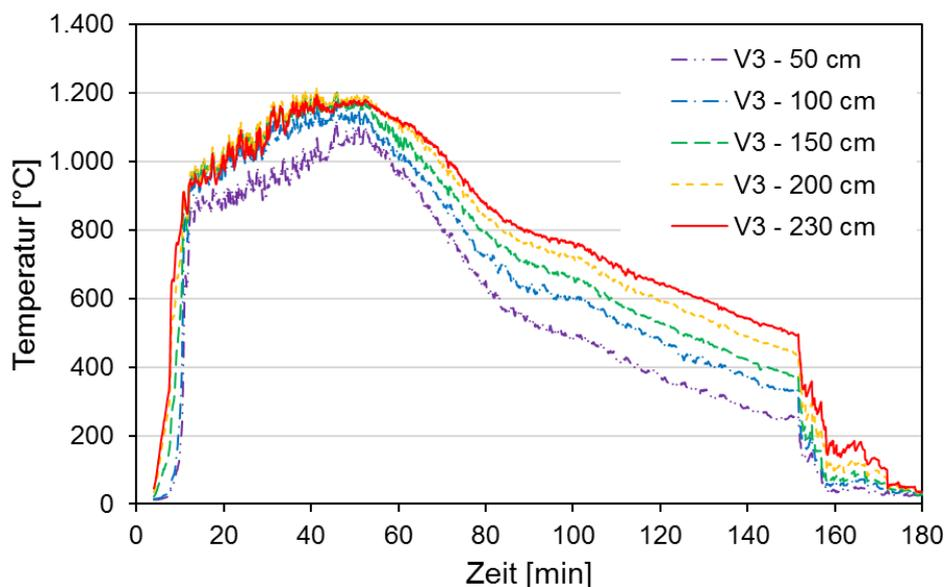
Bild 19 Temperatur-Zeit-Verläufe V3 im Brandraum in verschiedenen Höhen (Mittelwert)
