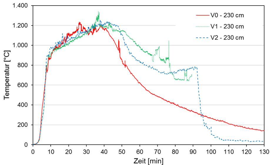
Bild 23 Vergleich Temperatur-Zeit-Verläufe V0, V1, V2 im Brandraum in 230 cm Höhe (Mittelwert)
