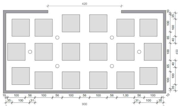
Bild 8 Grundriss mit Anordnung der 18 Holzkippen und der sechs Messbäume für V3
