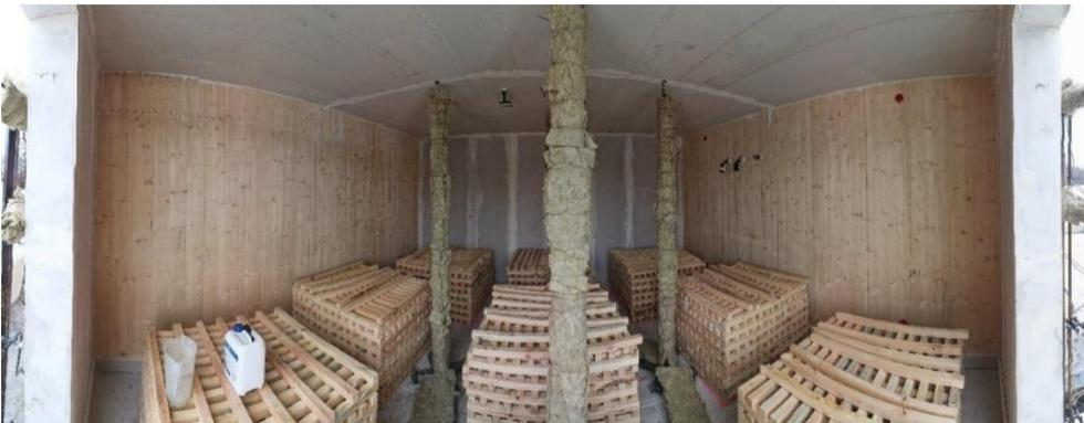
Bild 16 180° Dronenaufnahme aus dem Inneren des Brandraumes (V2)
