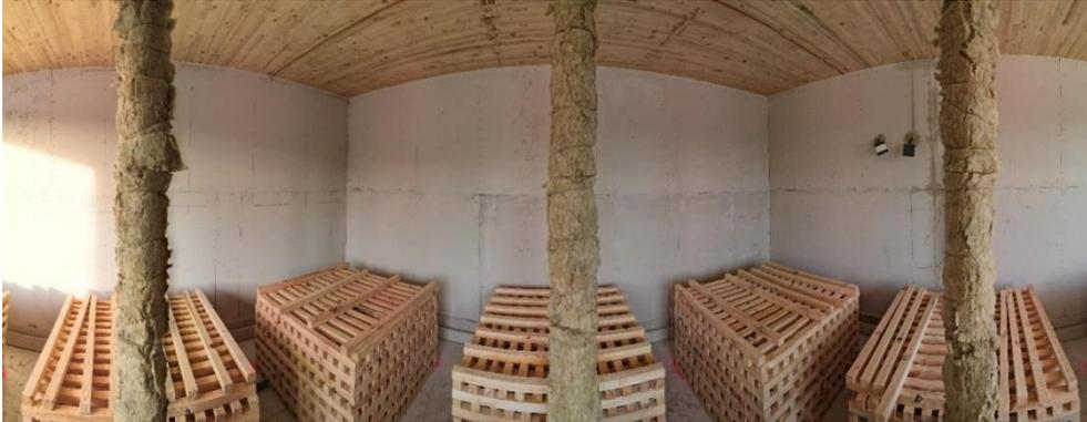
Bild 14 180° Dronenaufnahme aus dem Inneren des Brandraumes (V1)
