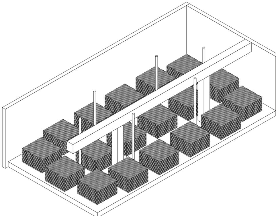
Bild 21 Anordnung der linearen Bauteile (zwei Stützen und Unterzug), der sechs Messbäume und der 18 Holzkippen bei V4
