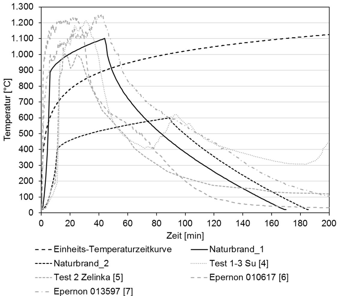
Bild 1: Die beiden gewählten repräsentativen Naturbrandkurven im Vergleich zur ETK sowie zu experimentellen Brandkurven
