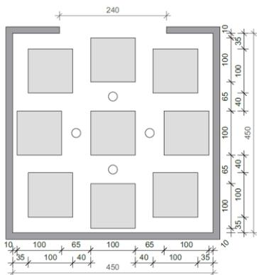
Bild 7 Grundriss mit Anordnung der neun Holzkippen und der vier Messbäume für V0, V1, V2
