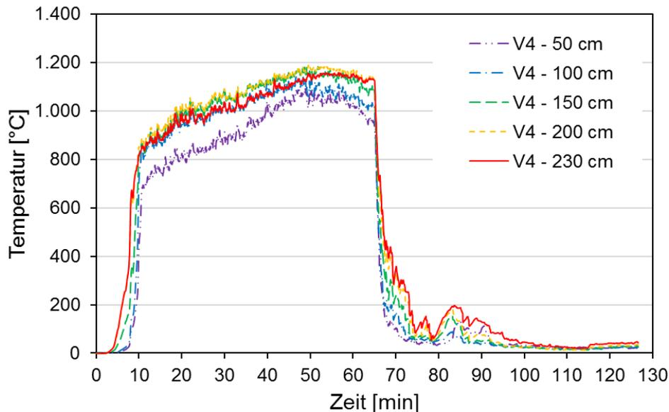
Bild 22 Temperatur-Zeit-Verläufe V4 im Brandraum in verschiedenen Höhen (Mittelwert)
