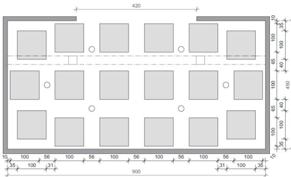
Bild 10 Grundriss mit Anordnung der 18 Holzkripen und der sechs Messbäume für V4
