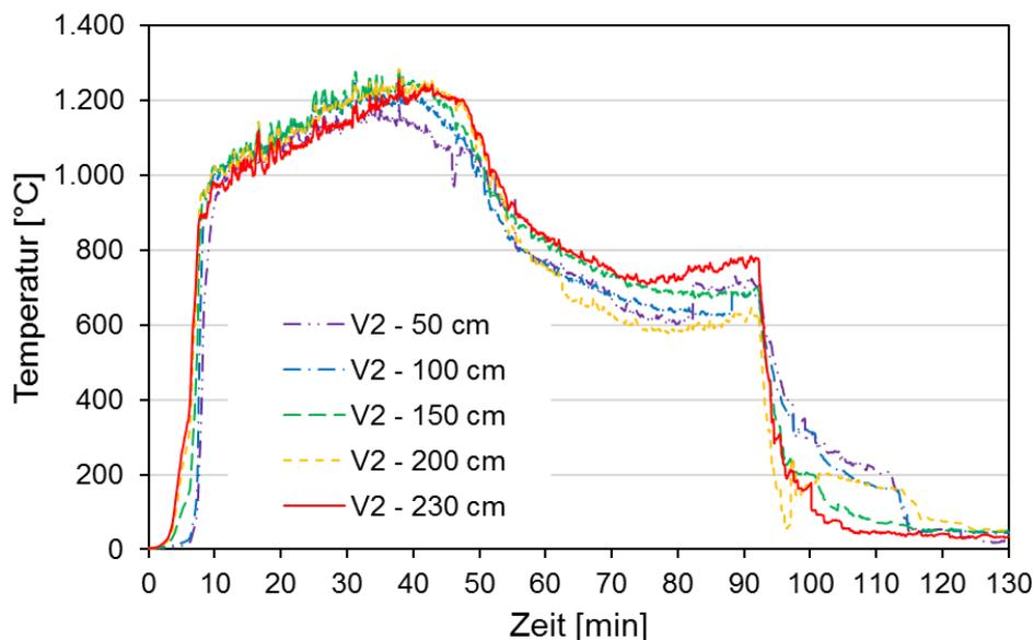
Bild 17 Temperatur-Zeit-Verläufe V2 im Brandraum in verschiedenen Höhen (Mittelwert)
