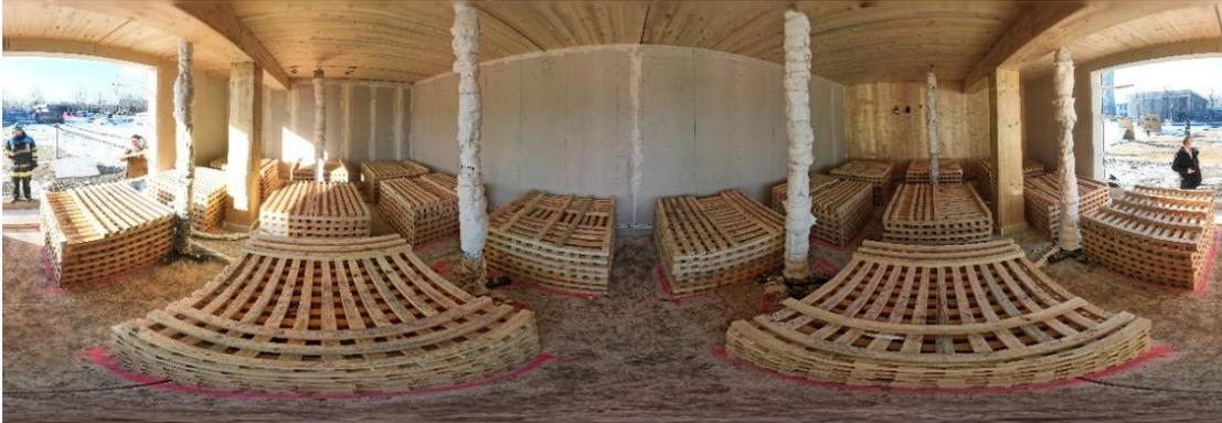
Bild 20 180° Dronenaufnahme aus dem Inneren des Brandraumes (V4)
