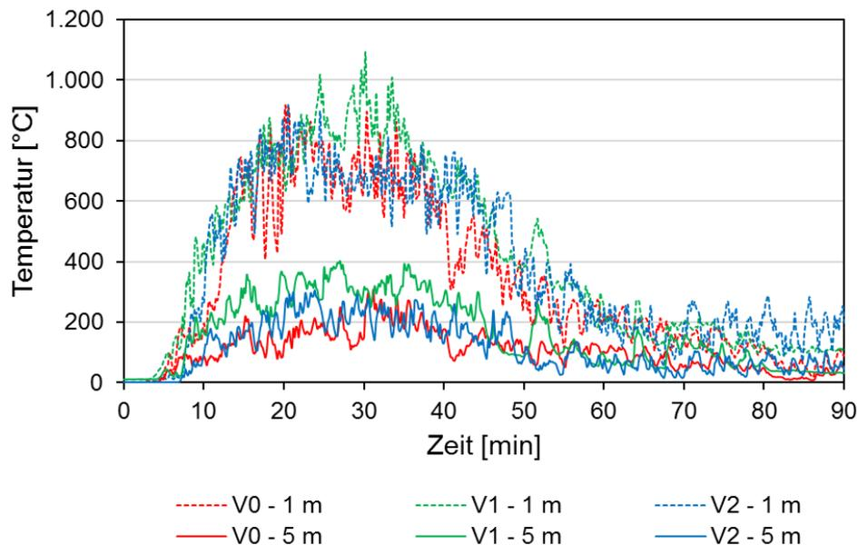
Bild 24 Vergleich der Temperatur-Zeit-Verläufe in der Mitte des Fassadenschildes in den Höhe 1 m und 5 m über die Brandraumöffnung für die Versuche V0, V1, V2
