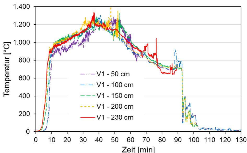
Bild 15 Temperatur-Zeit-Verläufe V1 im Brandraum in verschiedenen Höhen (Mittelwert)
