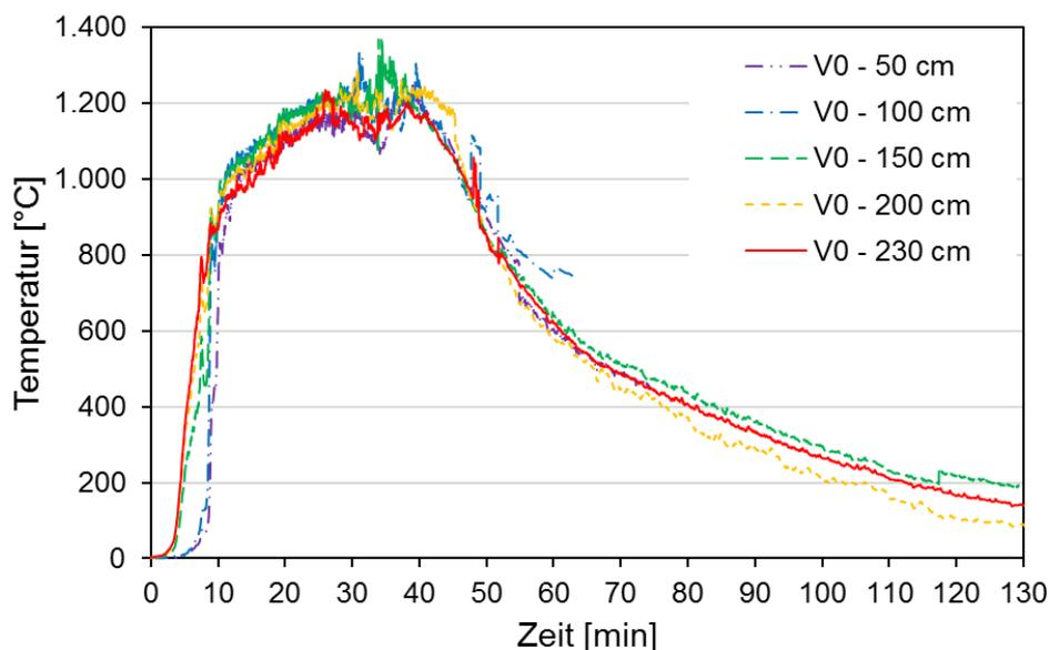
Bild 13 Temperatur-Zeit-Verläufe V0 im Brandraum in verschiedenen Höhen (Mittelwert)
