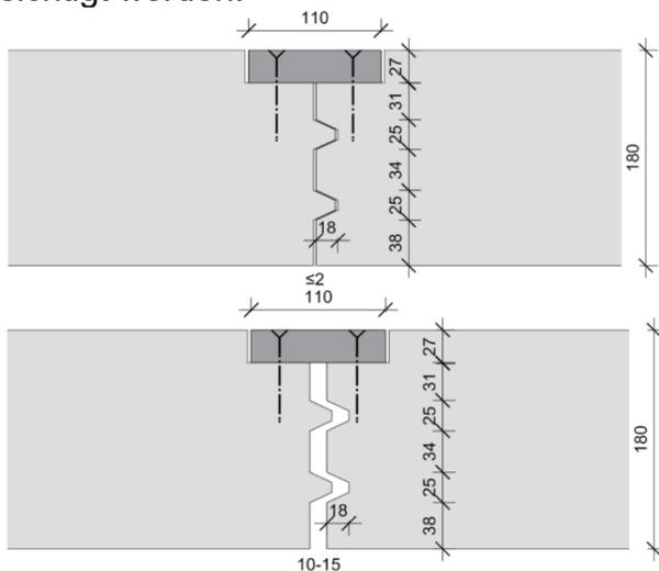
Bild 11 Darstellung von zwei beispielhaften Elementstößen der Brettschichtholzdecke
