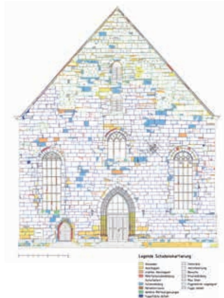
Mapping damages to the Regiswindiskirche, Lauffen am Neckar (streberwerk. Architekten GmbH, Stuttgart).
