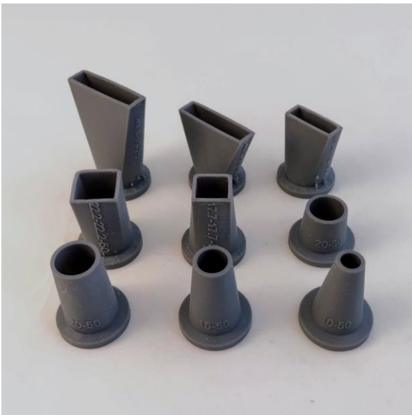
Abbildung 35: Unterschiedlich geformte Düsen hergestellt durch Stereolithografie (Foto D. Talke)
