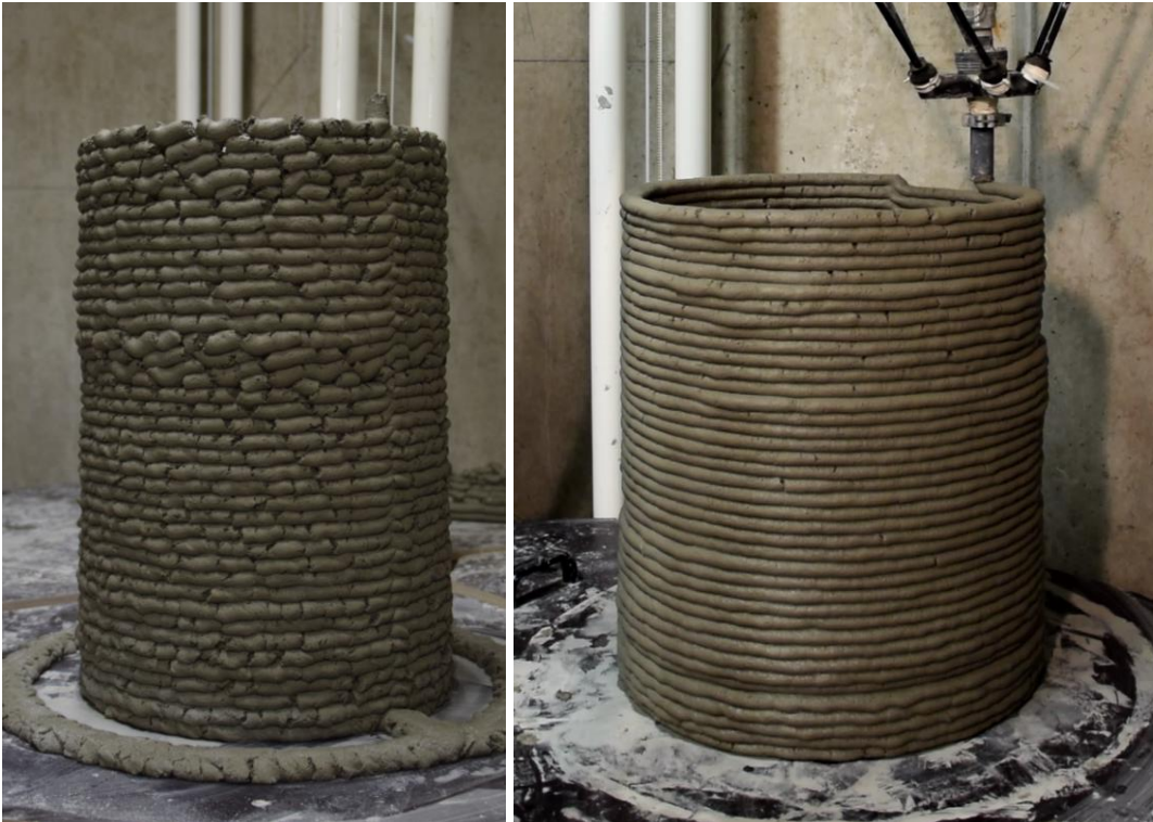
Abbildung 24: Zylinder auf Basis der selben Mischung ohne (links) und mit Luftporenstabilisierer (rechts). Durch den Einsatz des Luftporenstabilisierers konnten Risse in den Strängen signifikant reduziert werden (Fotos C. Matthäus)
