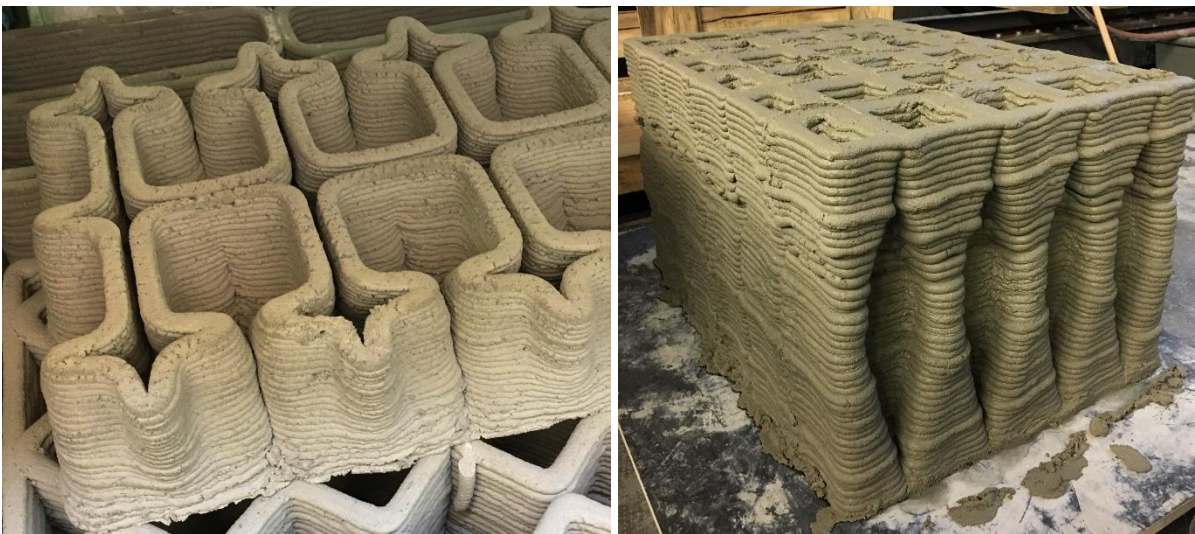
Abbildung 59: Beispiele für Testobjekte mit aus Doppelkeilen aufgebauten Geometrien zur Schaffung von Strukturen mit geschlossenen Hohlräumen (Fotos K. Henke)
