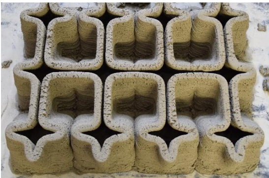
Abbildung 48: Struktur mit Überhängen zur Schaffung von geschlossenen Zellen (Foto C. Matthäus)
