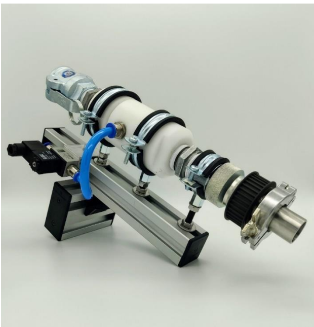
Abbildung 37: Endeffektor bestehend aus den Elementen (von links nach rechts) Schlauchkupplung, pneumatisches Quetschventil, Zahnrad für Zahnriemen zum Drehen der Düse, Schnellverbinder, Edelstahldüse (Foto D. Talke)
