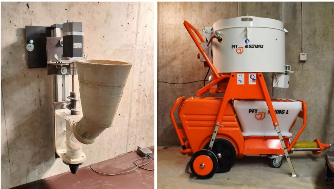
Abbildung 10: Förderpumpen: Schneckenextruder (links), PFT Swing L FC-400V Förderpumpe (hier mit aufgesetztem PFT Multimix 140 Plus Mischer) (rechts) (Fotos C. Matthäus)
