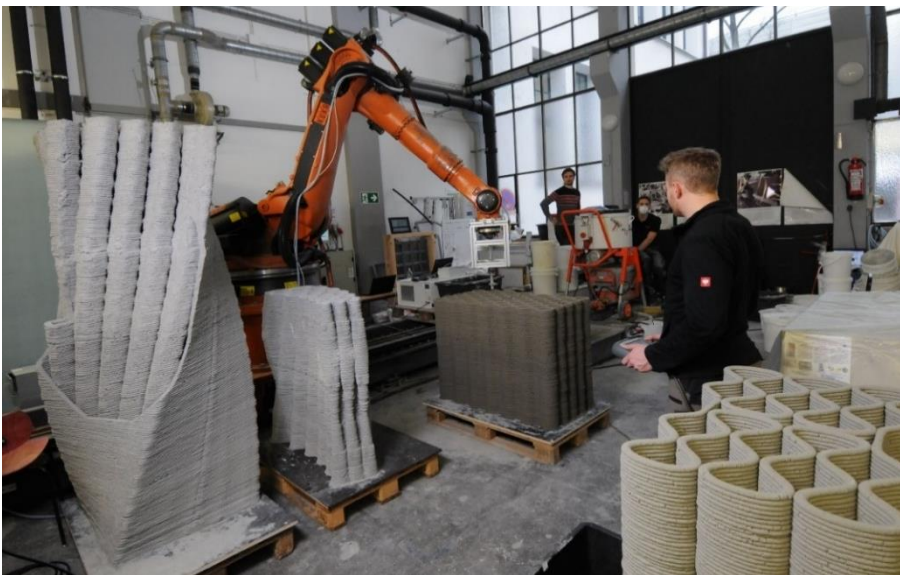
Abbildung 52: Additive Fertigung von Demonstratoren durch Extrusion von Leichtbeton (Foto K. Henke)
