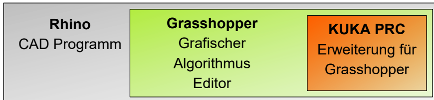
Abbildung 42: Übersicht der Beziehung zwischen Rhino, Grasshopper und KUKA PRC (Bild D. Talke)
