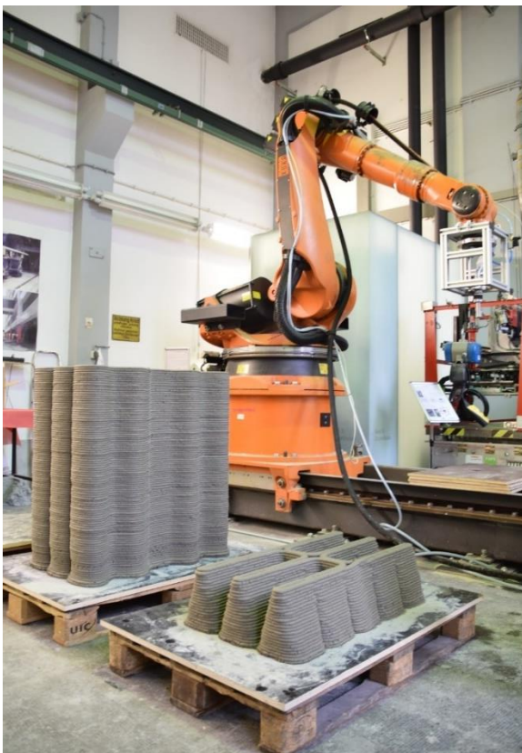
Abbildung 41: Industrieroboter Kuka KR 150 L110 des Lehrstuhls für Baurealisierung und Baurobotik, TUM (Foto C. Matthäus)
