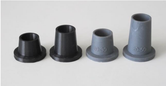
Abbildung 36: Mit verschiedenen Verfahren aus unterschiedlichen Werkstoffen hergestellte Düsen, Fused Filament Fabrication mit Polycarbonat, schwarz (links) und Stereolithografie mit Kunstharz, grau (rechts) (Foto K. Henke)
