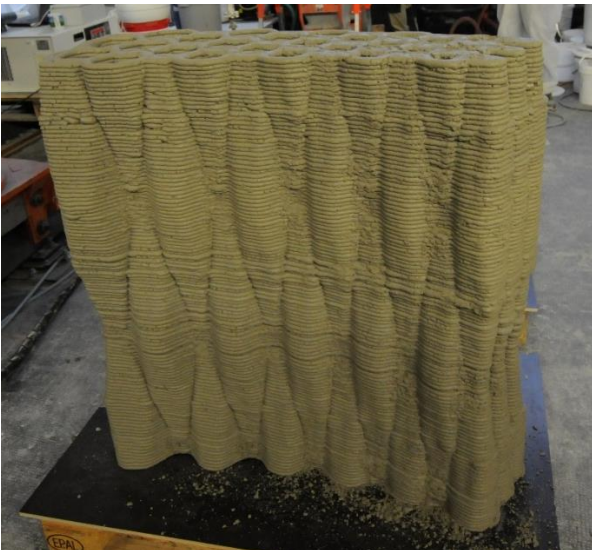
Abbildung 61: Wandelement mit inneren Zellstrukturen aus gestreckten Oktaederstümpfen (Foto K. Henke)
