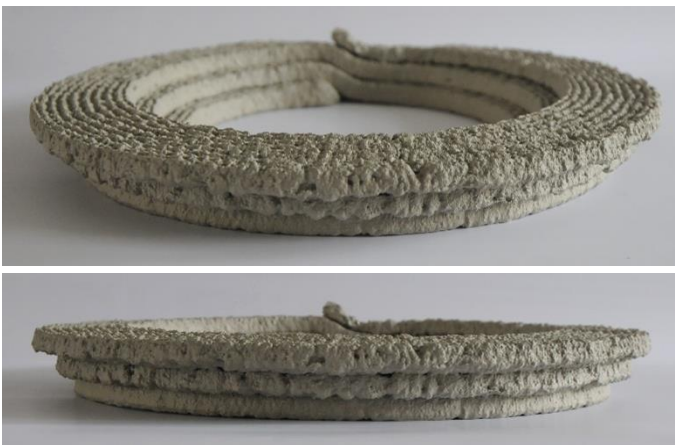
Abbildung 33: Stufen effekt bei rechteckigem Raupenprofil (Fotos K. Henke)
