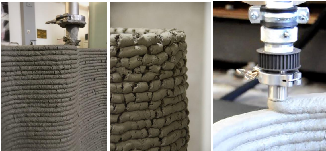
Abbildung 23: Oberflächenqualität beim Fertigungsprozess, links: oberflächliche Risse, Mitte: Abreißen der Stränge, rechts: Verformung von zu fließfähigem Material (Fotos C. Matthäus)
