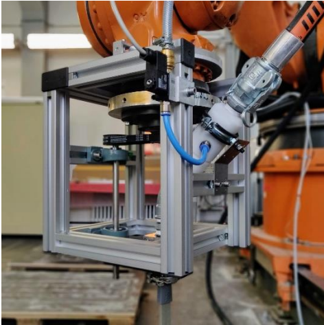
Abbildung 11: Drehbares Düsensystem der Exzentrerschneckenpumpe, an Industrieroboter montiert (Foto D. Talke)
