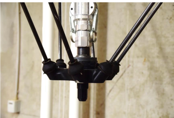
Abbildung 40: Werkzeugaufnahme des Opiliones Druckers mit runder Düse (unten) und Förderschlauchkupplung (oben) (Foto C. Matthäus)
