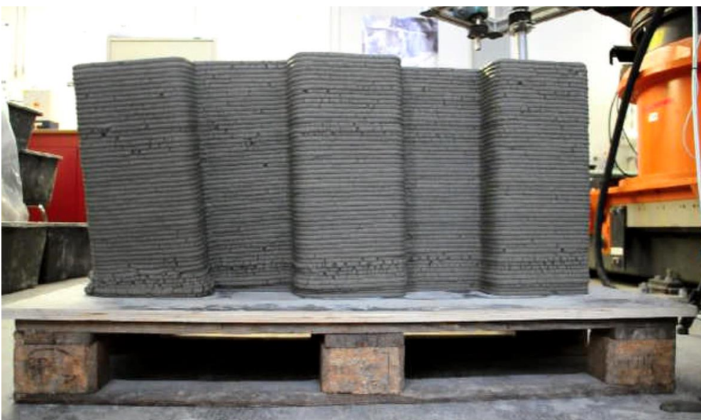
Abbildung 20: Plastisches Versagen der untersten Schicht (links im Bild) bei einer Druckgeschwindigkeit von 30s/Schicht (Foto C. Matthäus)
