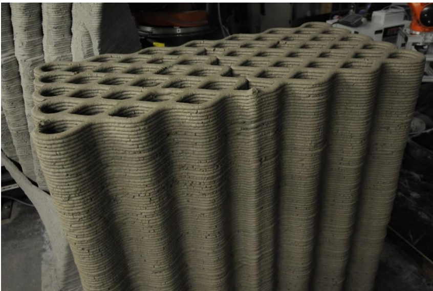
Abbildung 31: Mit feststehender, runder Düse im abstreifenden Verfahren hergestellte Rundraupen (Foto K. Henke)
