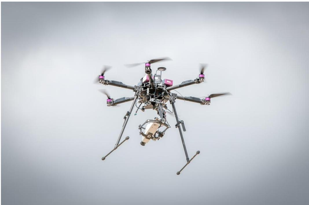
Abbildung 10: Das für die Untersuchungen verwendete unbemannte Luftfahrzeug mit verbautem bildgebendem Hyperspektralsensor (Quelle: EHRECKE, W. (2020), Landwirtschaftskammer Niedersachsen).
