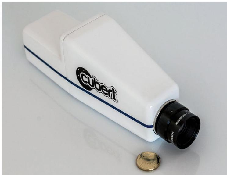
Abbildung 11: Der in den Untersuchungen verwendete Hyperspektralsensor UHD 185 Firefly des Unternehmens Cubert GmbH (Quelle: [www.bodkindesign.com](http://www.bodkindesign.com)).
