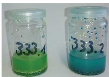
Abbildung 84: Lösungen aus dem ersten Test mit CupriSorb™ in DMSO nach zwei Tagen (links: \text{CuSO}_4 \cdot 5 \text{H}_2\text{O} ; rechts: Cu(I)Br).
