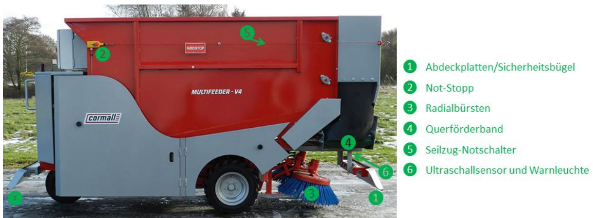
Abb. 7: Zentrale Einrichtungen beim Cormall MultiFeeder V4. (Cormall A/S 2014a)
