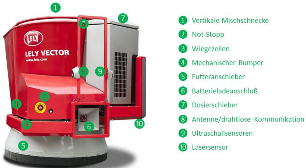
Abb. 5: Die wichtigsten Komponenten des Lely Vector Futtermisch- und Verteilwagens. (PitchEngine Inc. 2012)
