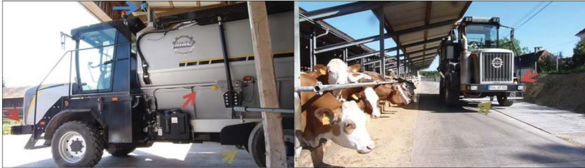
Abb. 3: Der Hirt-Selbstfahrer aus dem Forschungsprojekt mit der LfL und der TU Braunschweig. Zu sehen sind die Laser-Scanner für Kollisionschutz (grün) und Navigation (blau), sowie die Reißleinen und Not-Aus-Taster (rot). (Haidn 2014c)
