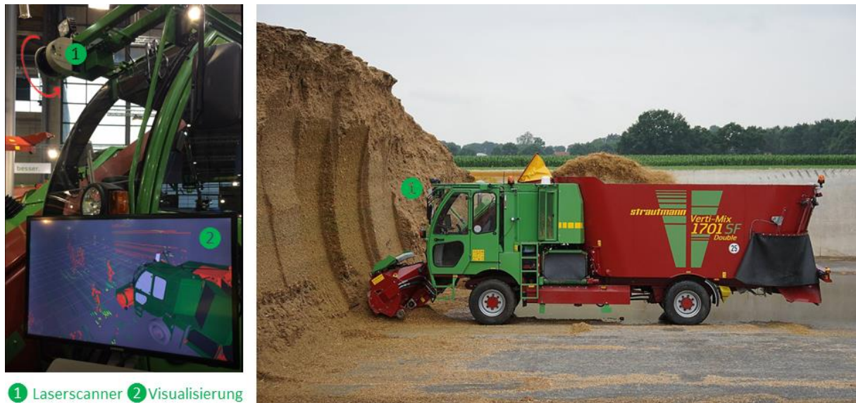
Abb. 13: Der rotierende 2D-Laserscanner ist oben an der Fahrerkabine angebracht. Über einen Monitor wurden die live-Messdaten visualisiert (links; Eigene Aufnahme). Bis auf wenige Details ist der Selbstfahrer-Futtermischwagen nicht als AFS identifizierbar (rechts). (©STRAUTMANN)
