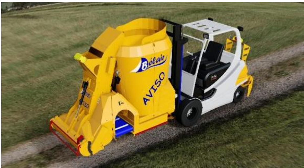
Abb. 10: Schema des Mischbehälters mit Fräsarm, angebaut an einen manuellen oder automatisierten Gabelstapler. (©BELAIR)
