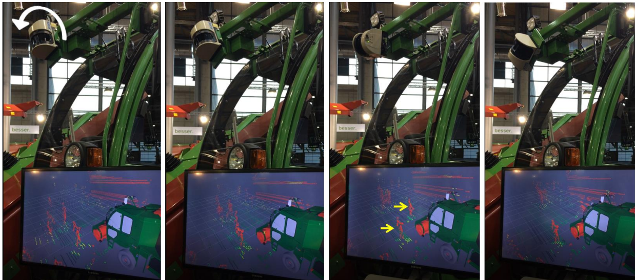
Abb. 21: Die Bildfolge zeigt die Rotation des 2D-Laser-Scanners (weißer Pfeil) in Fahrtrichtung mit dem Uhrzeigersinn und die Ausgabe der verarbeiteten Scannerdaten als 3D-Punktwolke auf einem Monitor. Zu erkennen sind vorbeigehende Messebesucher (gelbe Pfeile). (Reger et al. 2022a)
