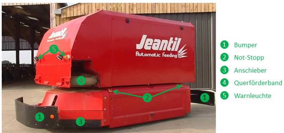
Abb. 8: Aufbau des Jeantil Automatic Feeding-Verteilwagens. (Jeantil o. J.)
