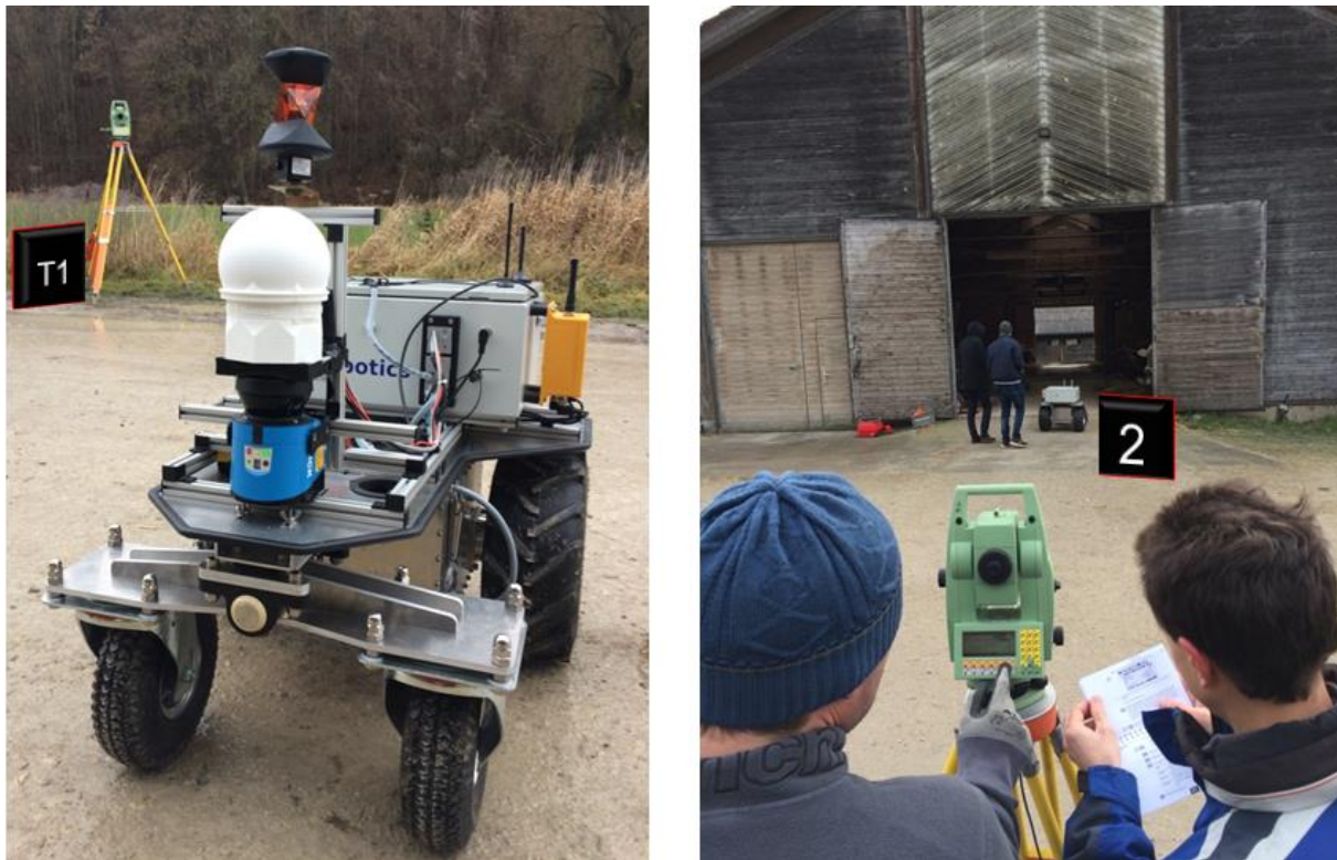
Abb. 33: Das Roboterfahrzeug mit Laserscanner (blau-schwarz), Radarscanner (weiß) und dem 360 Grad-Prisma (schwarz-orange) im Sichtfeld des Tachymeters. Zur Orientierung eingefügt wurden die Positionen T1 und 2. (Eigene Aufnahmen)
