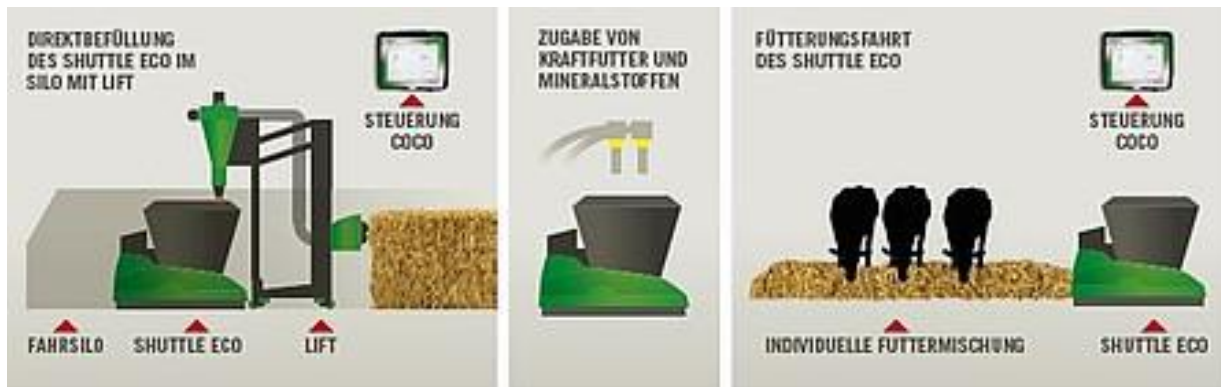
Abb. 17: Die Prozessschritte der Fütterung im NANO Concept von Wasserbauer. (Wasserbauer GmbH o. J.b)
