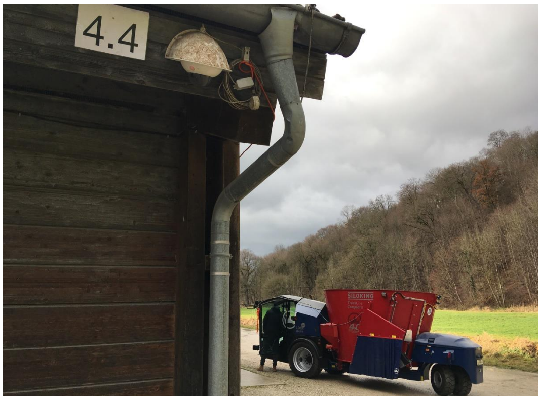
Abb. 35: Die IP-Kameras wurden im und außen am Stall angebracht und zeichneten die gesamte Fahrstrecke des Testfahrzeugs auf. Die gut sichtbare Nummerierung der Kameras half bei der Zuordnung und schnelleren Erfassung im Protokoll. (Eigene Aufnahme)
