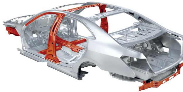
Abbildung 5-3: Automobilkarosserie mit rot gekennzeichneten PHS-Bauteilen [Wan-2017, S. 6]
